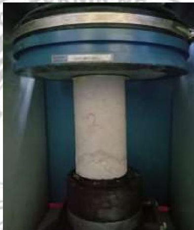
Pengujian Kuat Tekan
