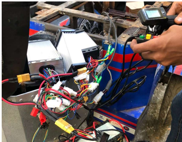
Gambar 4.4 Rangkaian kontrol dengan 3 mode Percepatan
