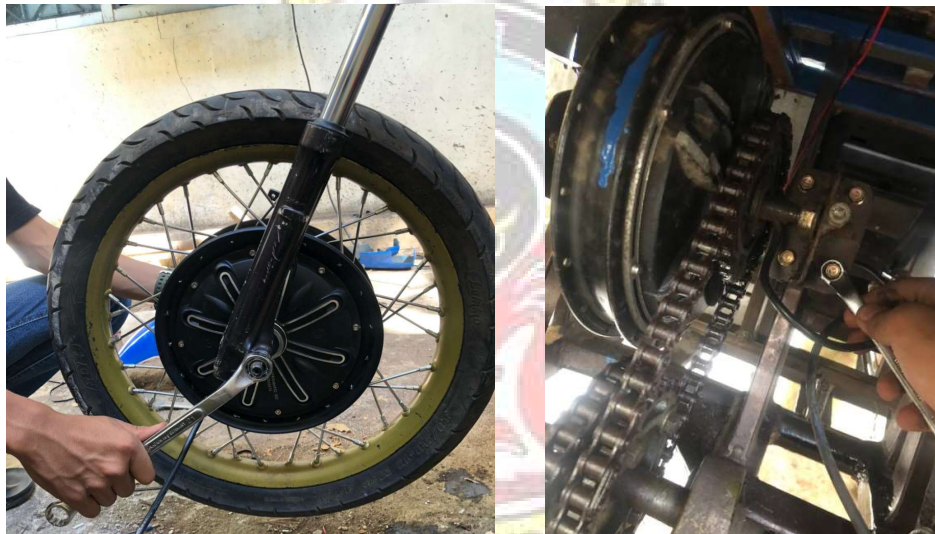
Gambar 4.3 Pemasangan motor BLDC bagian dan Belakang
