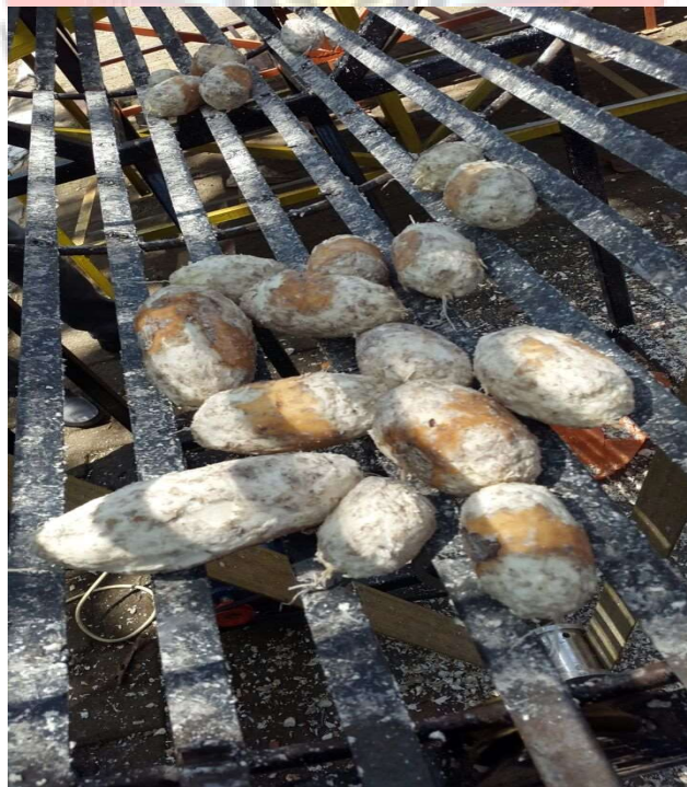
Gambar pengujian menggunakan mesin pengupas kulit singkong dengan plat datar saja
