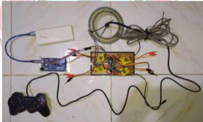
Gambar 4. 7 Rangkaian Elektronik Hubungan antara Joystick , Smartphone , dan Arduino Mega 2560
