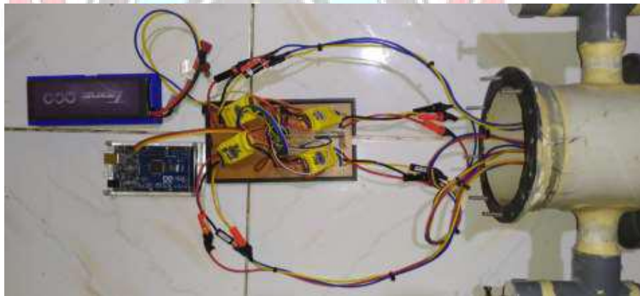
Gambar 4. 9 Rangkaian Elektronika Hubungan antara Brushless DC Motor , ESC, dan Arduino Mega 2560
