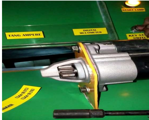
Gambar L2.10 Posisi pinion pada saat pull in coil dan hold in coil
