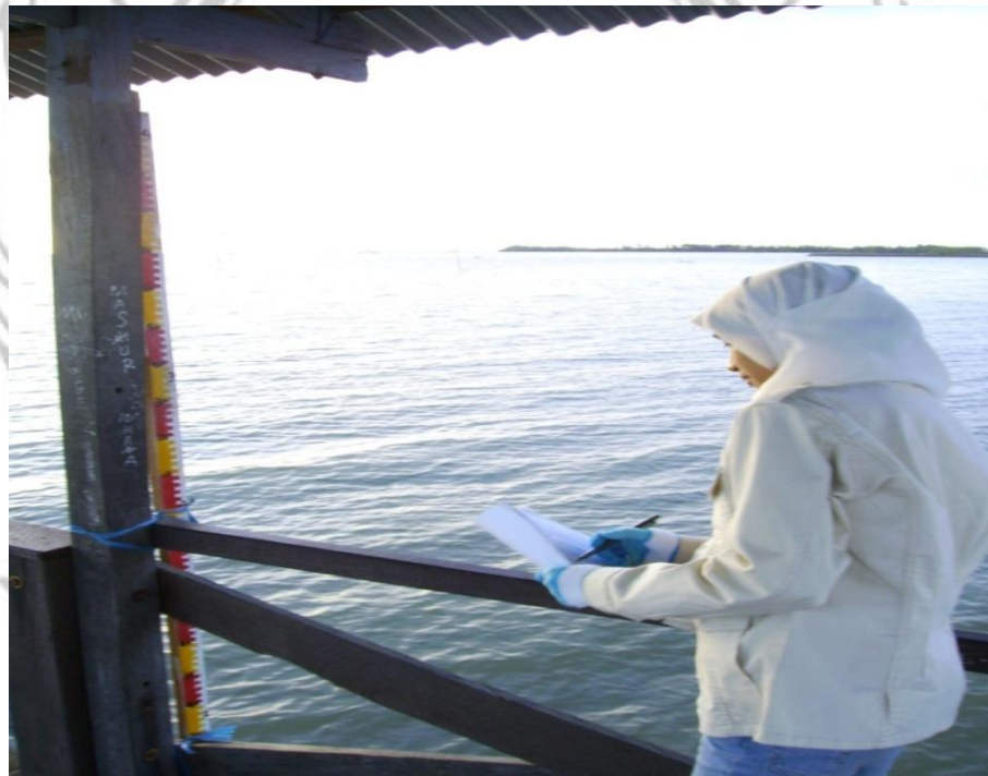
Gambar 34. Pencatatan muka air oleh Pengamat
