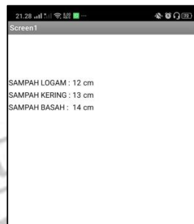
Gambar 34 Pengujian Monitoring Menggunakan MIT AppInventor
