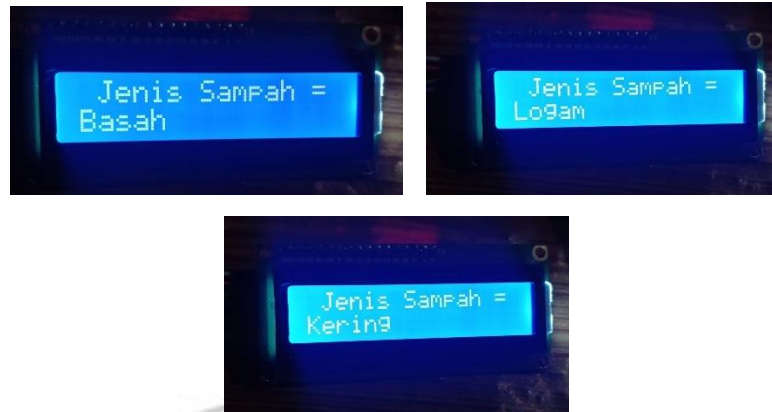
Gambar 29 Tampilan Pada LCD Hasil Pengujian Sampah
