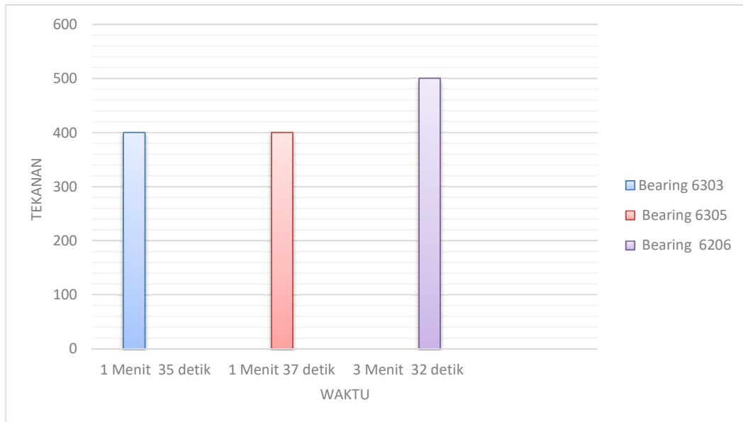
Gambar 4.3 Tekanan terhadap Waktu Pemasangan
