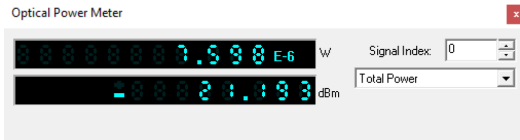
Gambar 4.5 Daya terima ONT pada ODP-TMA-FB/28 (ODP terjauh)
