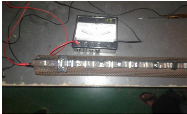
Gambar 7. Pengujian Beban Tahanan Geser 10 Ohm
