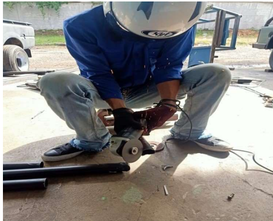
Gambar 3.3 Pemotongan besi pipa untuk rangka transaxle
