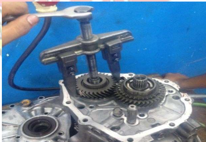
Gambar 3.14 Melepas driven gear ke-5
