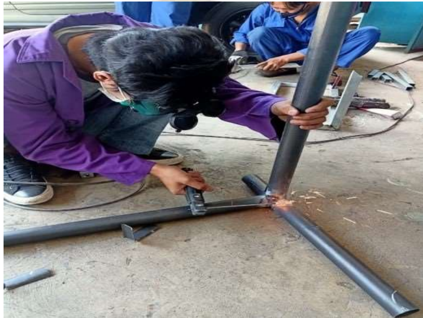
Gambar 3.5 Proses pengelasan Pada proses pengelasan ini menggunakan las listrik 450 Watt dan Elektroda 2.0 mm
