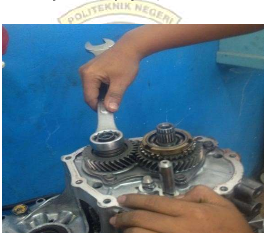
Gambar 3.12 Membuka mur set belakang output shaft
