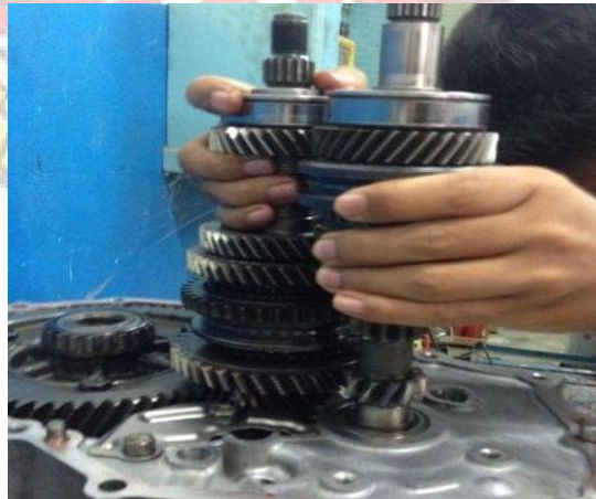
Gambar 3.15 Melepas input shaft assembly dan output shaft assembly
