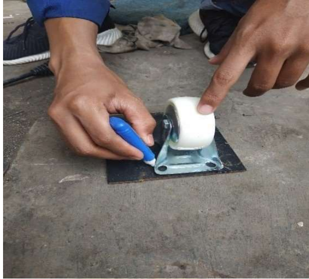
Gambar 3.10 Membuat dudukan roda
