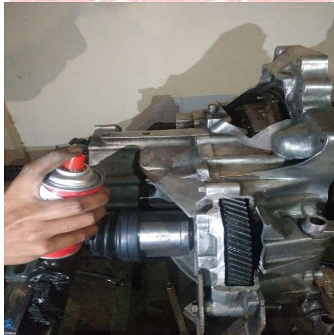
Gambar 3.21 Hasil pengecatan pada komponen transmisi
