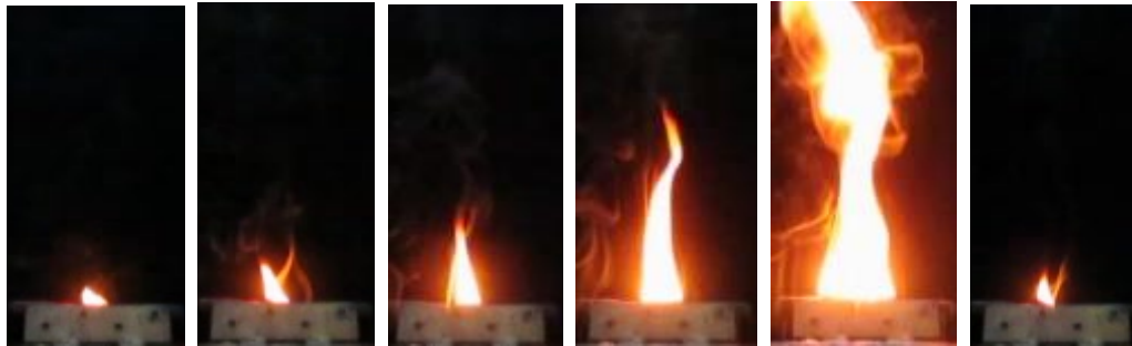
Gambar 2. Proses nyala api selama pembakaran resin damar
