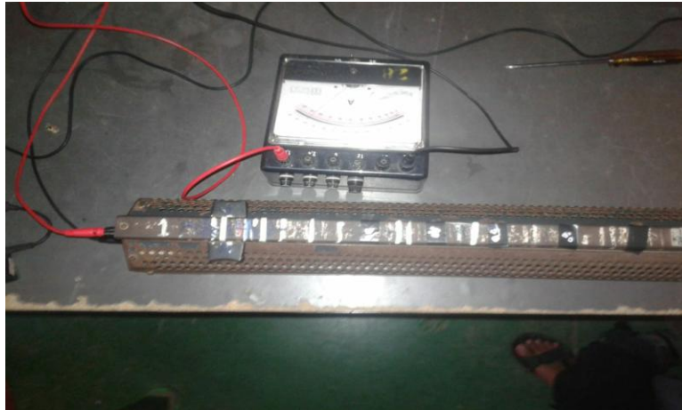
Gambar 7. Pengujian Beban Tahanan Geser 10 Ohm
