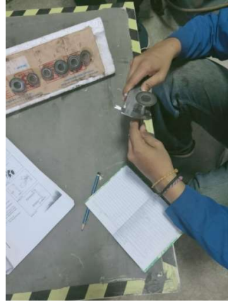
Gambar 20. Pengukuran panjang pegas klep Gambar 21. Pemeriksaan valve stem
