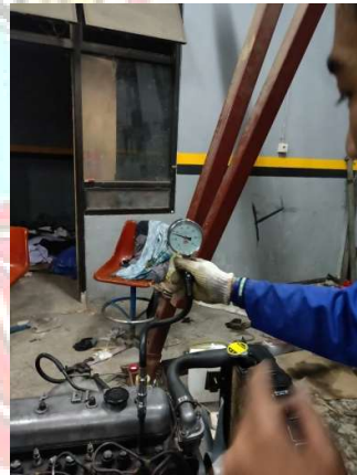
Gambar 22. Pengukuran runout camshaft Gambar 23. Pengukuran kompresi
