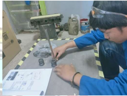
Gambar 17. pengukuran celah ring piston
