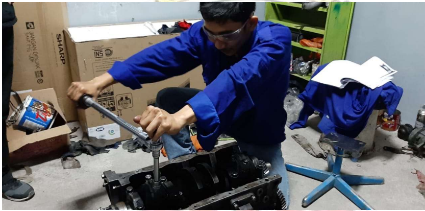
Gambar 24. Pengencangan baut piston dan crankshaft
