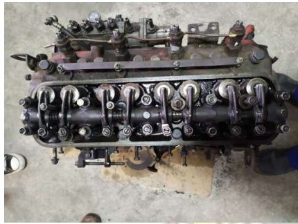
Gambar 7. Pembongkaran rocker arm assembly
