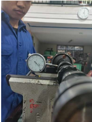
Gambar 22. Pengukuran runout camshaft Gambar 23. Pengukuran kompresi
