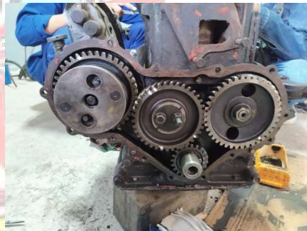
Gambar 9. Pembongkaran gear seat
