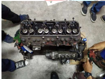
Gambar 8. Pembongkaran head silinder
