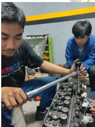
Gambar 25. Pemasangan head cylinder
