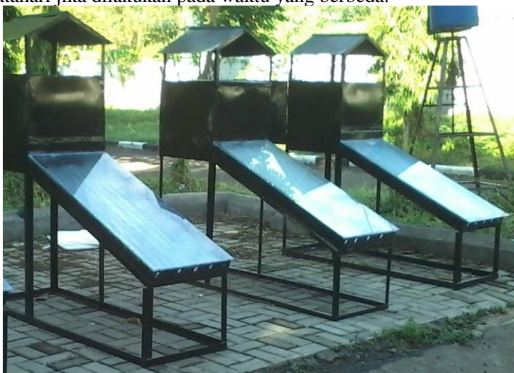
Gambar 2. Hasil rancang bangun pengering surya tipe rak dengan aliran natural
