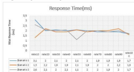
Gambar 13 Grafik response time dengan menggunakan metode least connection
