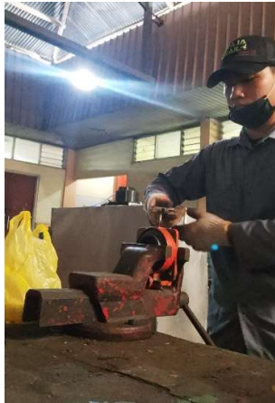
f. Proses pembuatan drat untuk pemasangan pressure gauge
