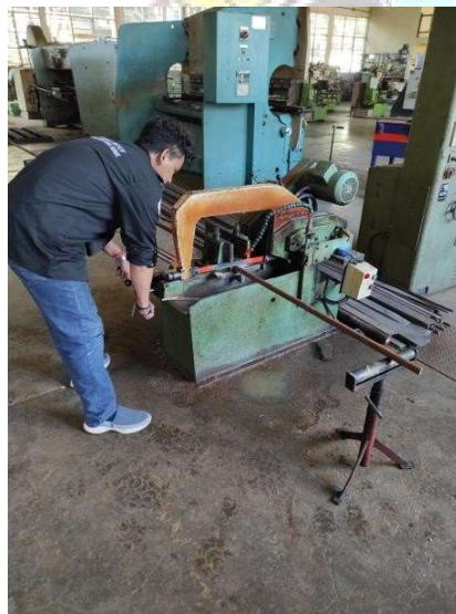
c. Pemotongan plat menjadi punch
