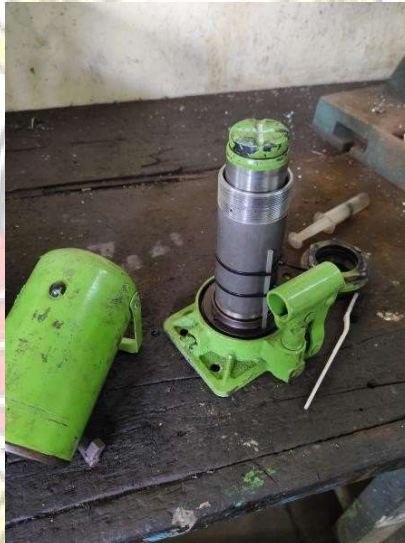
b. Pembongkaran dan pemasangan pipet untuk menghisap oli
