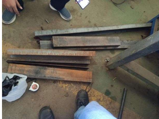
a. Pemotongan baja UNP
