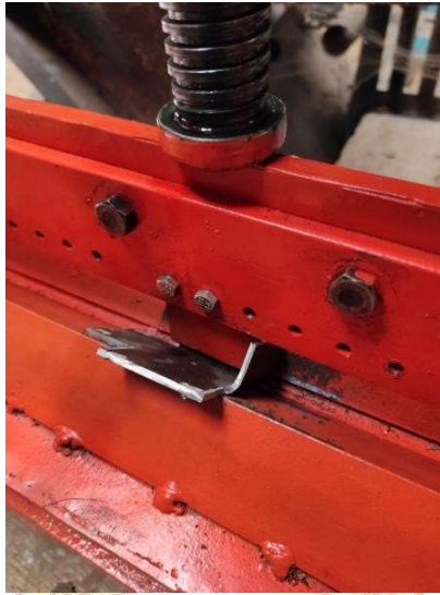
j. Proses bending empat sisi plat
