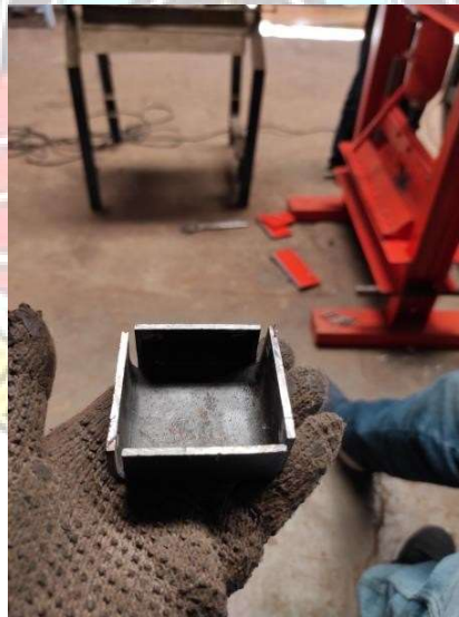
k. Hasil bending empat sisi plat
