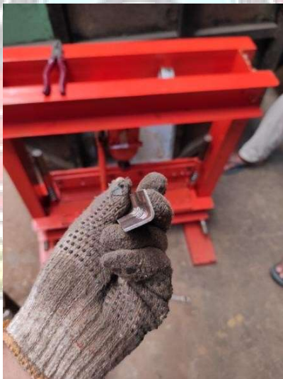
i. Hasil bending satu sisi plat
