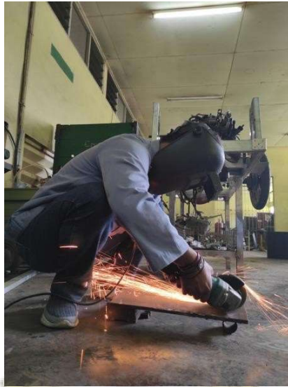
c. Pemotongan plat menjadi punch
