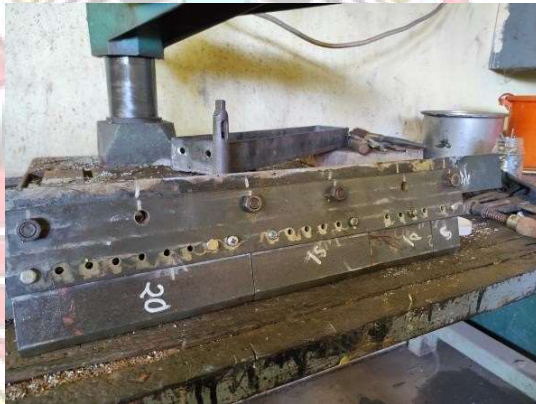
e. Proses pengeboranudukan punch , plat pengunci punch dan punch .
