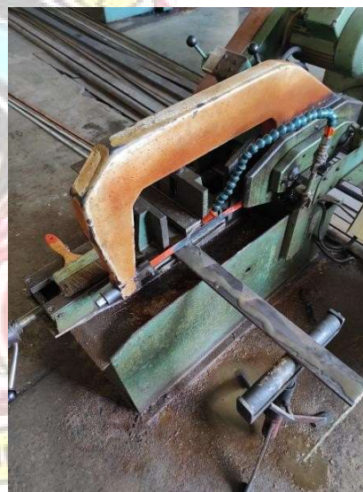
c. Pemotongan plat menjadi punch
