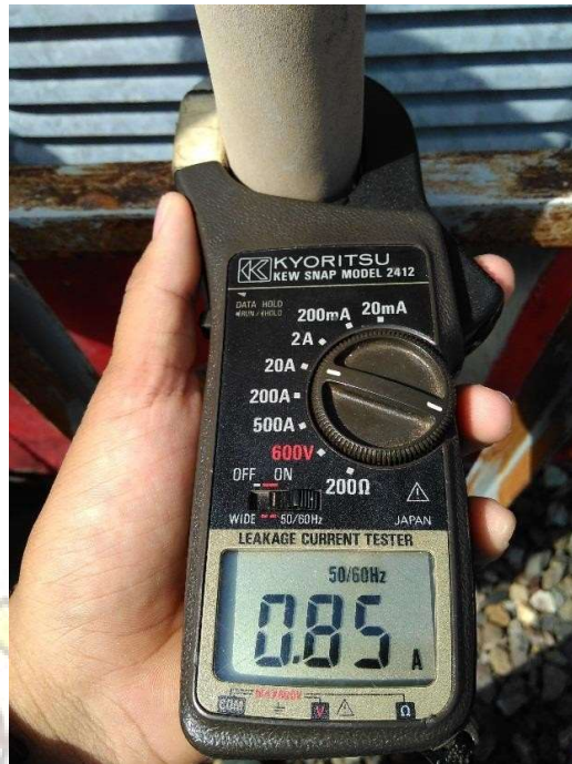
Gambar 29. Nilai pengukuran arus netral
