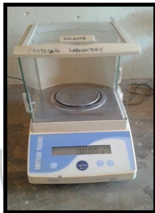
Timbangan digital dengan ketelitian 0,001 gram
