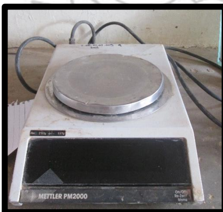
Timbangan digital dengan ketelitian 0,01 gram
