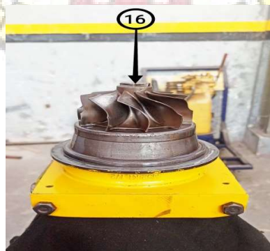
Gambar 3.2 Pemasangan Turbine Wheel
