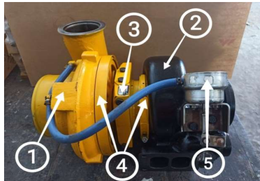
Gambar 2.3 Komponen Turbocharger pada engine C15
