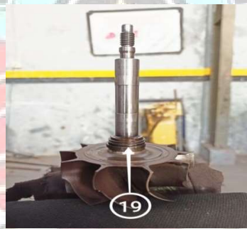
Gambar 2.9 Pelepasan Seal Piston Ring
