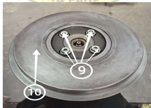
Gambar 3.11 Pemasangan Back plate dan Baut
