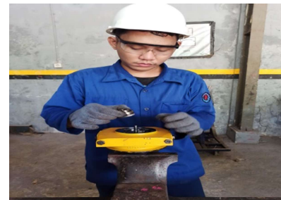
Gambar 4.7 Pelepasan Baut, Thrust Bearing , dan Collar Thrust Lepaskan ring piston (14) dari collar thrust (13).
