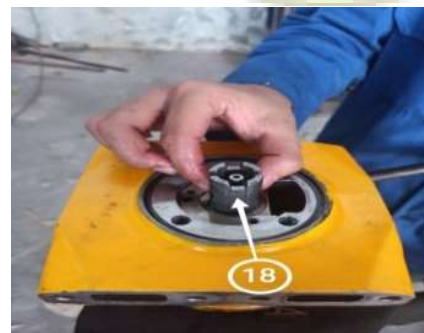
Gambar 4.19 Pemasangan Spacer Bearing
