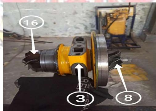
Gambar 3.13 Pengencangan Compressor Wheel
