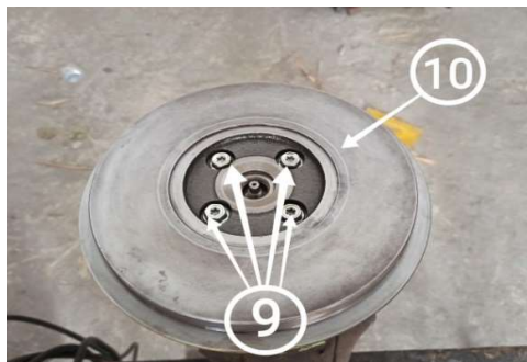
Gambar 2.4 Pelepasan Baut dari Back Plate
