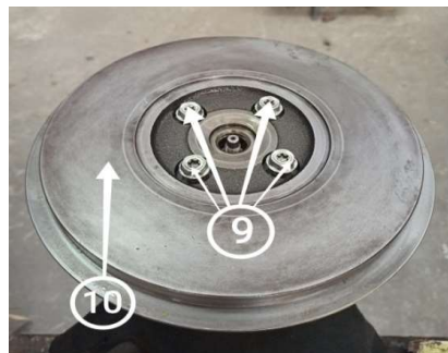
Gambar 4.25 Pemasangan Back plate dan Baut
