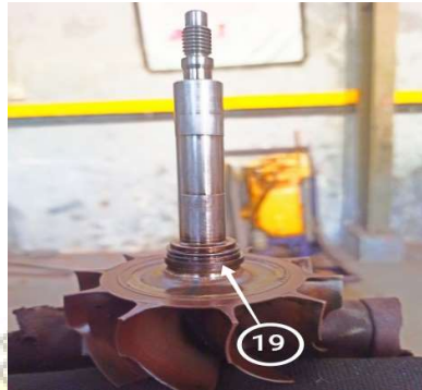
Gambar 3.1 Pemasangan Seal Piston Ring
