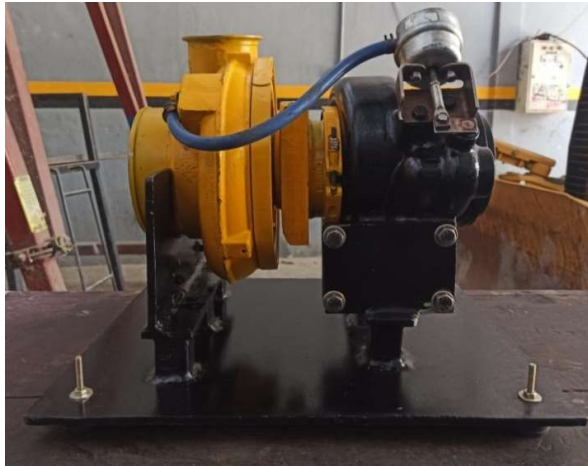
Gambar 4.1 Pemasangan Turbocharger ke Rangka Dudukan
