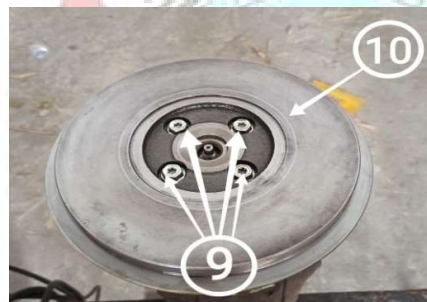
Gambar 4.6 Pelepasan Baut dari Back Plate
