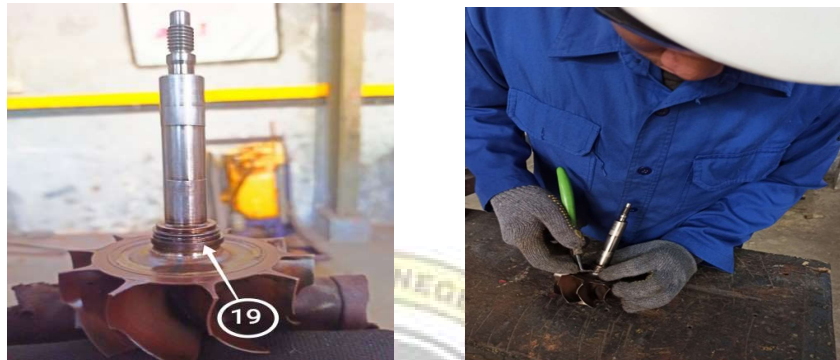
Gambar 4.15 Pemasangan Seal Piston Ring
