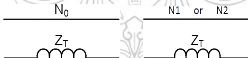
(a) Rangkaian urutan nol (b) Rangkaian urutan positif/negatif Gambar 4.2 Rangkaian Impedansi Urutan Nol dan Positif/Negatif Trafo
