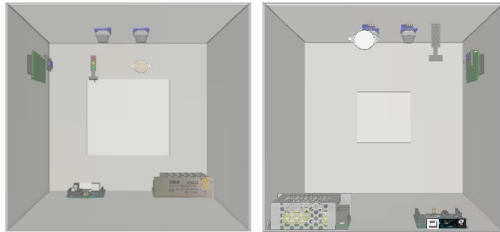
Gambar 3.4 Rancangan Box Akrilik tampak kanan dan kiri
