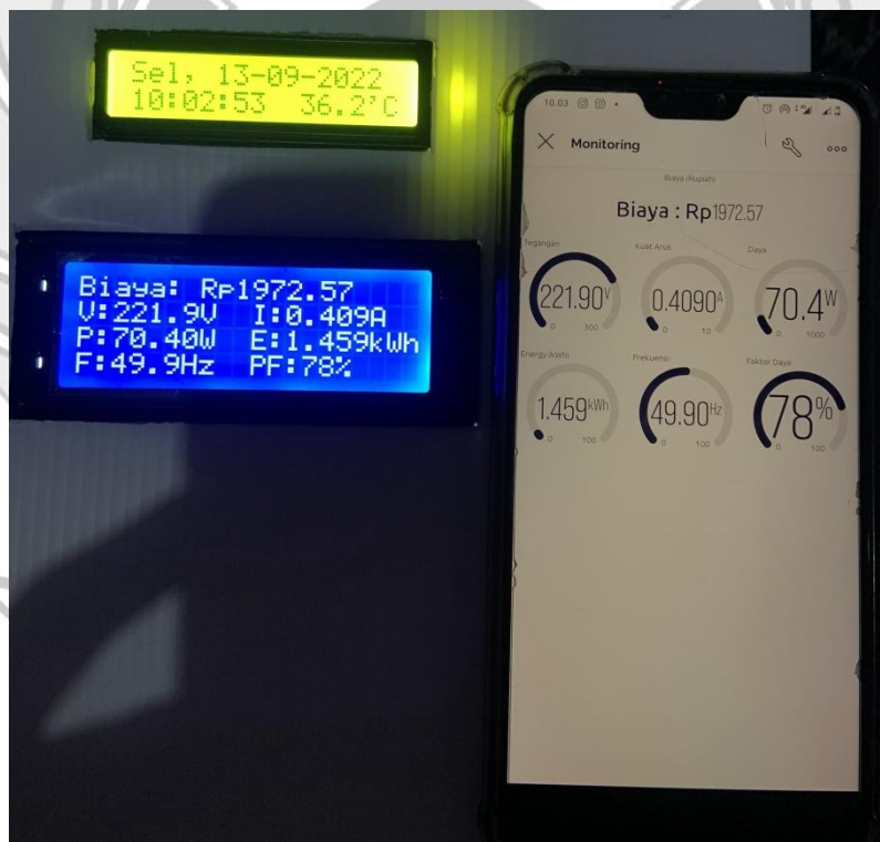
Gambar 8. Tampilan Pada LCD perangkat dan pada Aplikasi blynk
