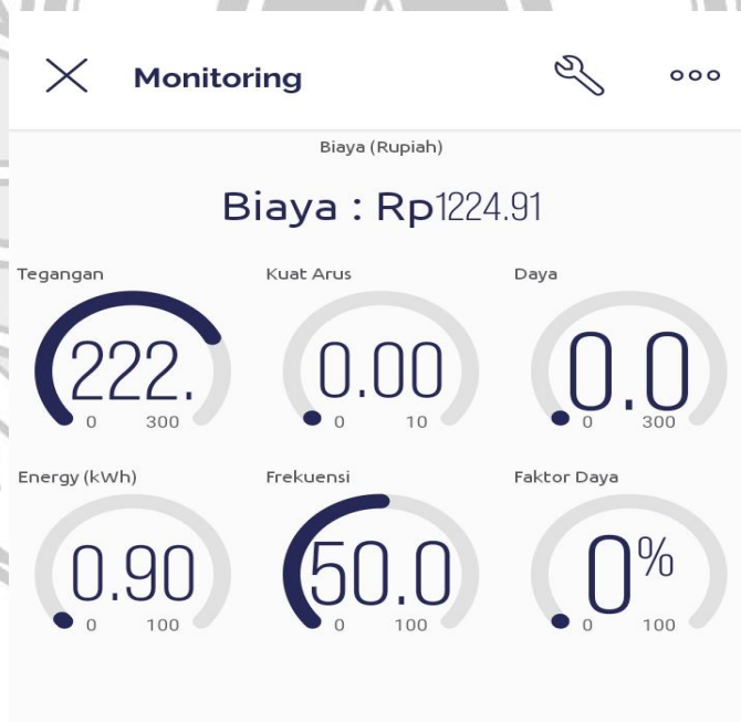
Gambar 6. Tampilan pada aplikasi blynk pada device monitoring
