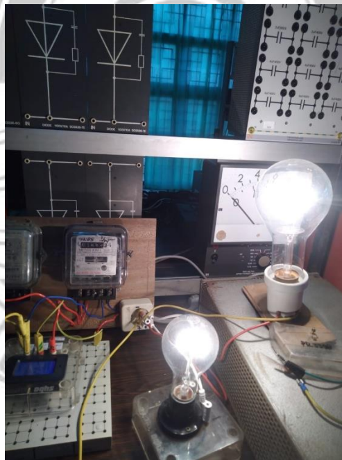
Gambar rangkaian percobaan kWh meter pascabayar analog
