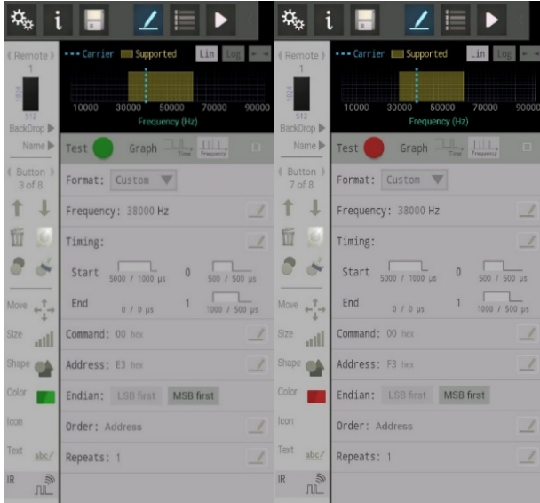
Gambar 6. Konfigurasi Tombol Saklar 3 ON dan OFF.
