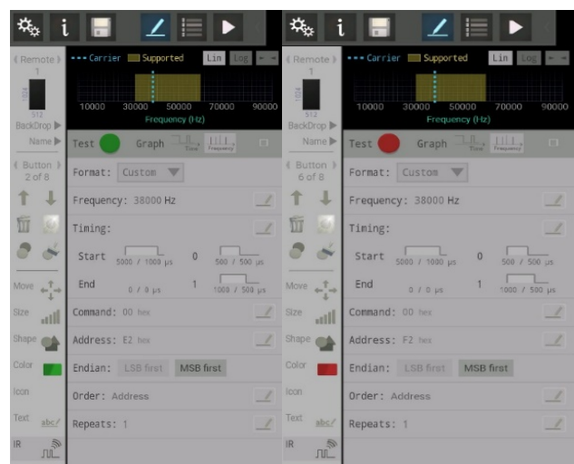
Gambar 5. Konfigurasi Tombol Saklar 2 ON dan OFF.
