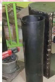
Gambar 3.37 Hasil *Bending* Plat Spiral
