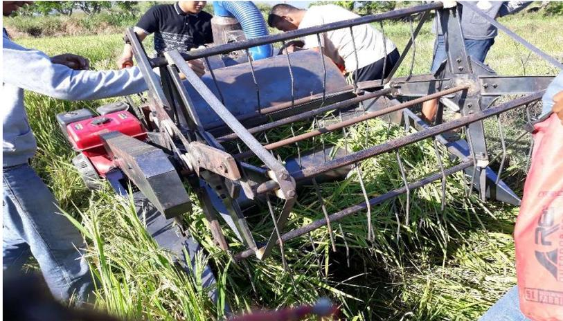
Gambar 4.10 Proses Pengujian Mesin Dengan Putaran 900 Rpm
