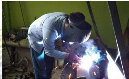
Gambar 3.39 Proses Pengelasan Spiral
