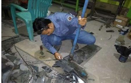
Gambar 3.40 Proses Pemotongan Plat *Trip*
