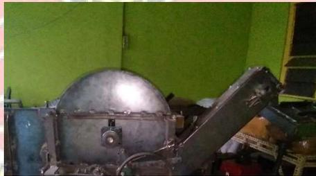
Gambar 3.50 Pemasangan Conveyor Case Dan Cover body
