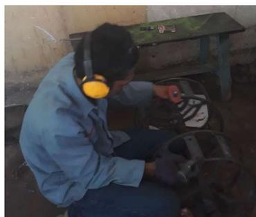
Gambar 3.24 Proses Pengelasan Rangka Ban Bagian Depan
