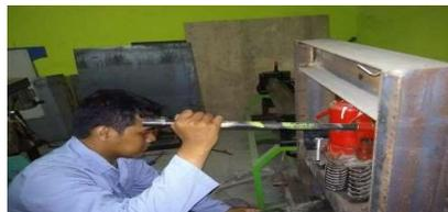
Gambar 3.32 Proses menekuk besi untuk ban
