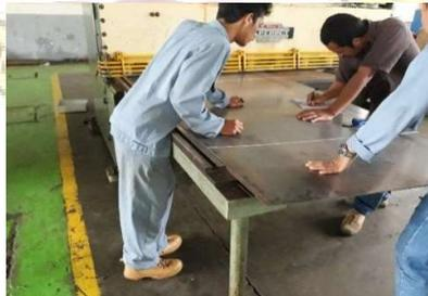
Gambar 3.19 Memotong Benda Kerja
