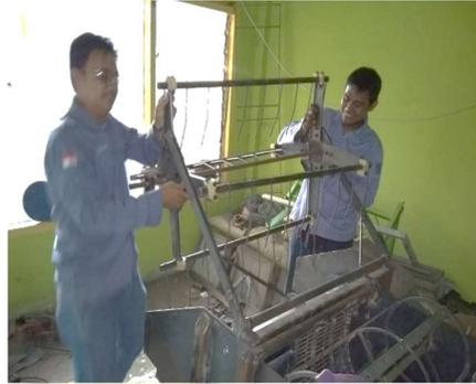
Gambar 3.49 Proses Pemasangan Penyangga Sisir, Dudukan *Roller* Penahan Sisir dan Sisir
