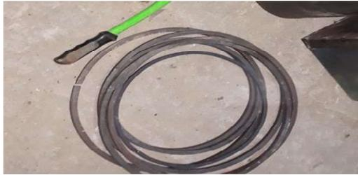
Gambar 3.22 Hasil *Roll* Besi Rangka Ban Bagian Depan Dan Belakang
