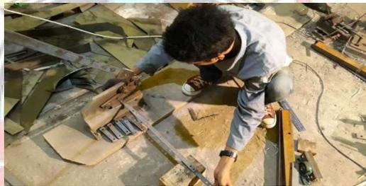
Gambar 3.23 Memotong Besi Penghubung Rangka Ban Bagian Depan dan Belakang
