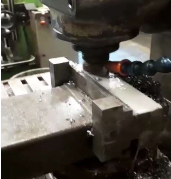
Gambar 4 proses facing untuk meletakkan landasan
