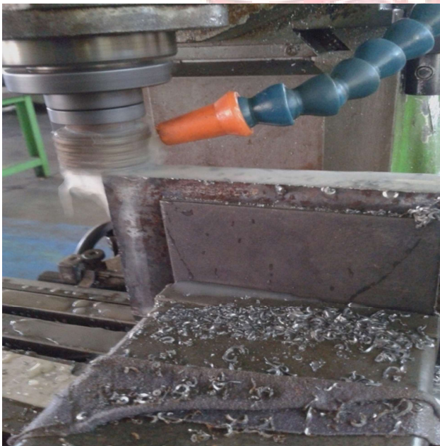
Gambar 6 proses facing pada landasan
