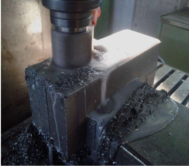
Gambar 1 pada saat permukaan ragum di fecing
