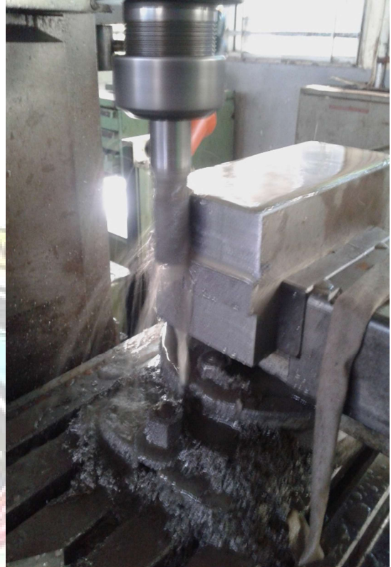
Gambar 2 pada saat bagian depan ragum di fecing
