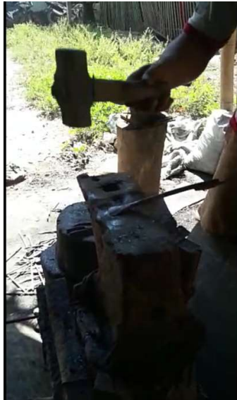
Gambar 1.16 Penempaan dengan cara manual, objek tempaan besi tulangan polos
