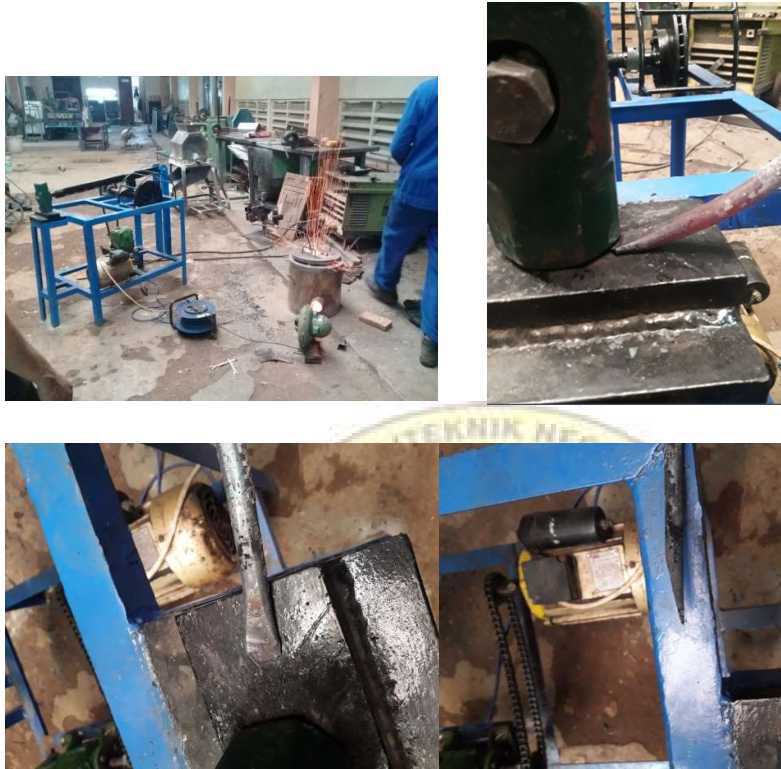
Gambar 1.15 Proses pengujian mesin penempa menggunakan objek besi Tulangan polos
