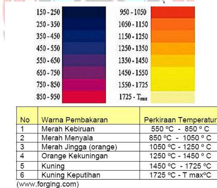
Gambar 1.1 Tabel warna dan temperatur pemanasan baja
