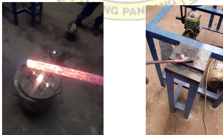
Gambar 1.14 Spesimen pada suhu layak tempa dan suhu tisak layak tempa
