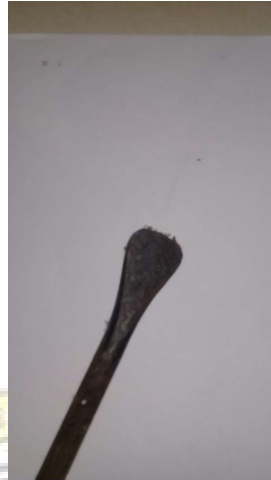
Gambar 1.16 Penempaan dengan cara manual, objek tempaan besi tulangan polos
