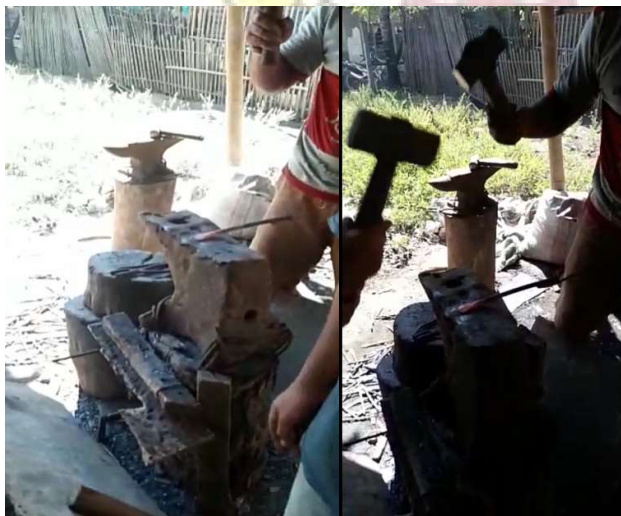
Gambar 1.15 Proses pengujian mesin penempa menggunakan objek besi Tulangan polos
