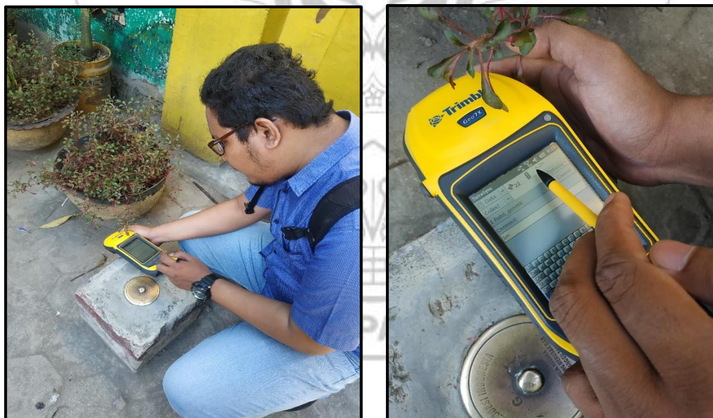
Gambar Lampiran 6. Dokumentasi Perekaman Titik Koordinat dan Elevasi pada Titik BM Batangkaluku Kabupaten Gowa
