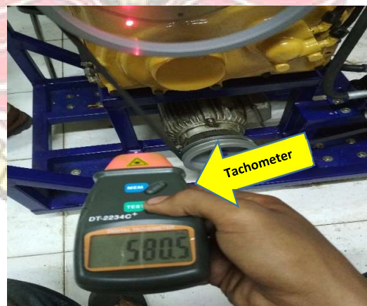
Gambar : 34. Pengukuran input countershaft menggunakan tachometer
