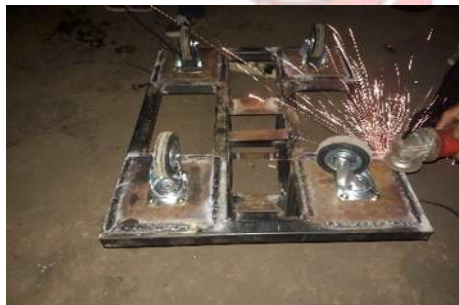
Gambar : 57. Proses menghaluskan bekas las dan pemasangan tiang penyanggah pegangan pada stand .
