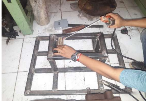
Gambar : 55. Proses pemasangan plat dudukan countershaft dan plat dudukan roda pada stand .
