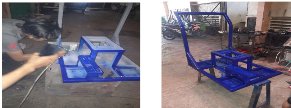
Gambar : 63. Pemberian warna biru pada stand countershaft .
