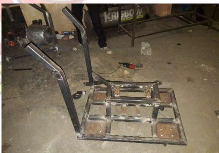
Gambar : 57. Proses menghaluskan bekas las dan pemasangan tiang penyanggah pegangan pada stand .
