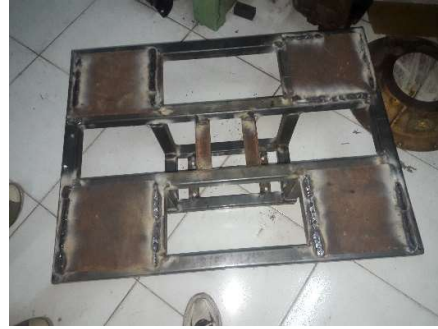
Gambar : 55. Proses pemasangan plat dudukan countershaft dan plat dudukan roda pada stand .
