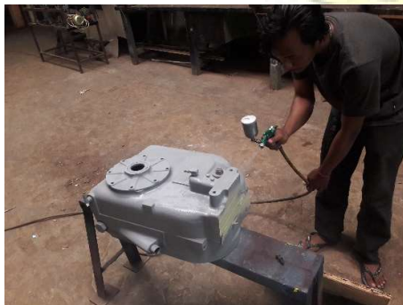
Gambar : 60. Pemberian warna dasar dan warna kuning pada housing
