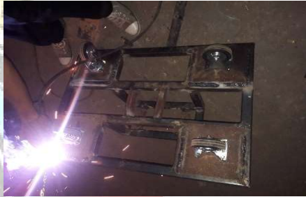
Gambar : 56. Proses pemasangan roda dan memperbaiki las pada plat dudukan roda
