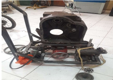
Gambar : 64. Proses pemasangan countershaft ke stand sebelum pewarnaan
