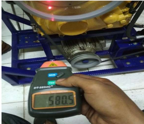
Gambar : 69. pengukuran menggunakan tachometer
