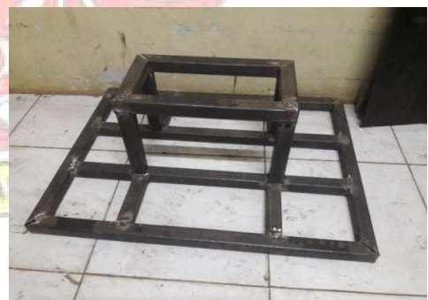
Gambar : 54. Proses pembuatan rangka stand bagian bawah dan dudukan countershaft
