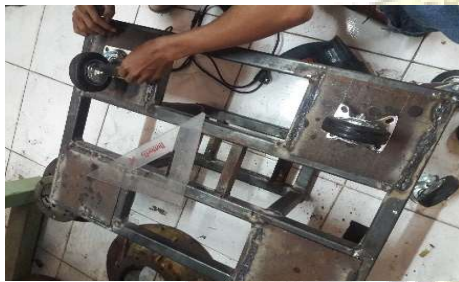
Gambar : 56. Proses pemasangan roda dan memperbaiki las pada plat dudukan roda
