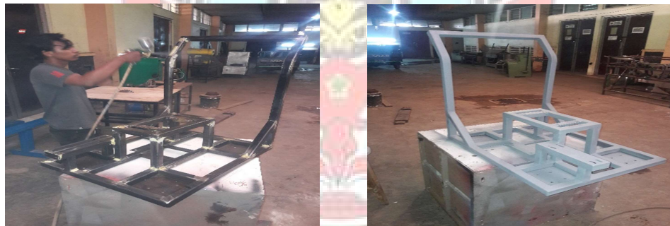
Gambar : 62. Proses pemberian warna dasar pada stand countershaft .
