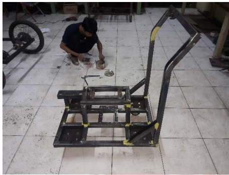
Gambar : 59. Proses pemberian dempul untuk menutupi lubang pada bekas pengelasan.
