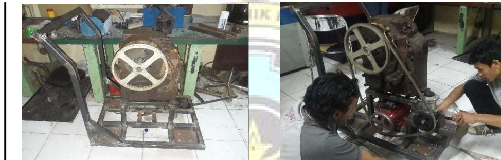
Gambar : 65. Countershaft setelah pemasangan puller , sabuk dan pompa hidrolis
