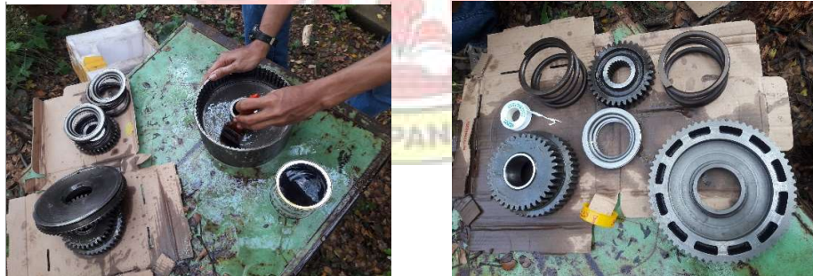
Gambar : 12. Proses pencucian dan penjemuran komponen countershaft
