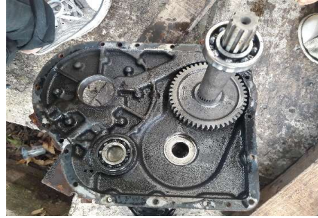
Gambar : 44. Susunan gear dalam casing dan cover penutup countershaft
