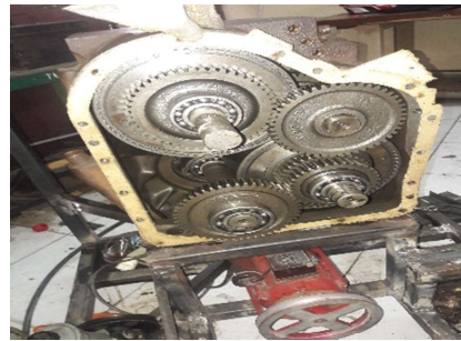
Gambar : 64. Proses pemasangan countershaft ke stand sebelum pewarnaan
