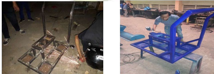
Gambar : 14. Proses pembuatan dan pewarnaan stand countershaf
