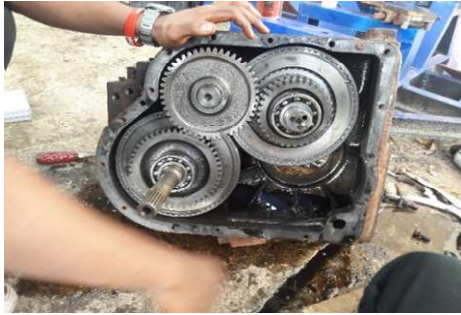
Gambar : 44. Susunan gear dalam casing dan cover penutup countershaft
