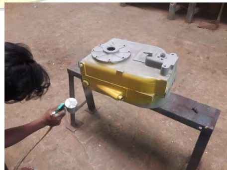
Gambar : 60. Pemberian warna dasar dan warna kuning pada housing
