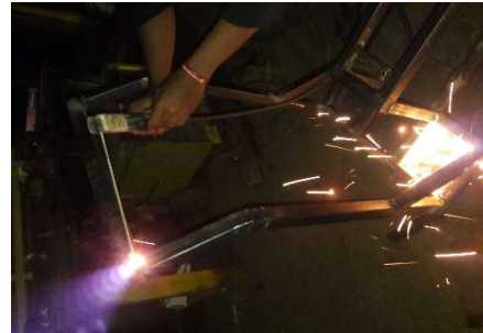
Gambar : 58. Proses pengelasan pengangan pada stand
