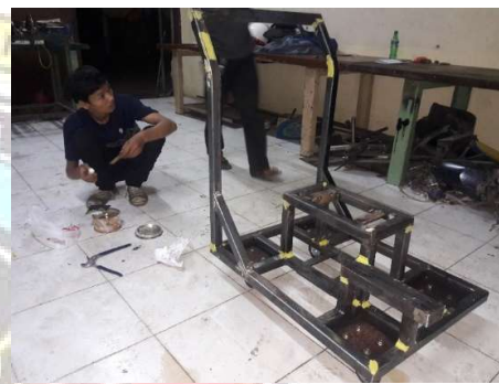
Gambar : 59. Proses pemberian dempul untuk menutupi lubang pada bekas pengelasan.
