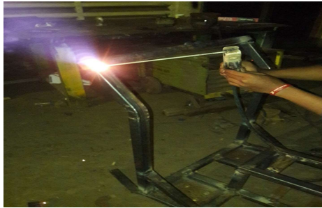
Gambar : 58. Proses pengelasan pengangan pada stand
