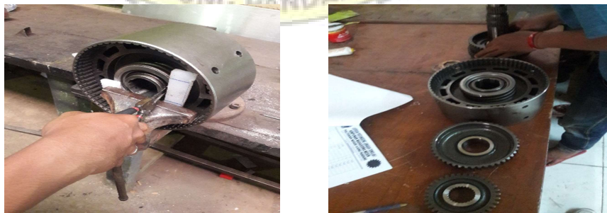
Gambar : 13. Proses perakitan komponen countershaft
