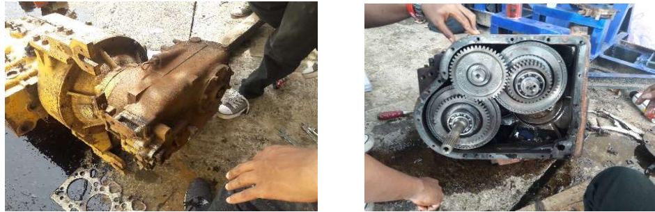
Gambar : 11. Proses pelepasan countershaft dari engine
