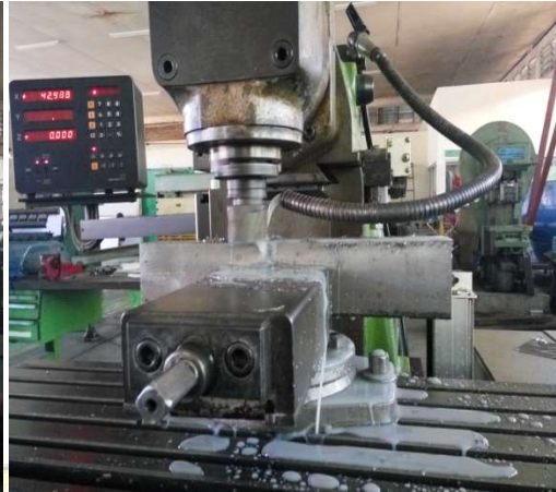
Gambar Facing besipejal (kotak)
