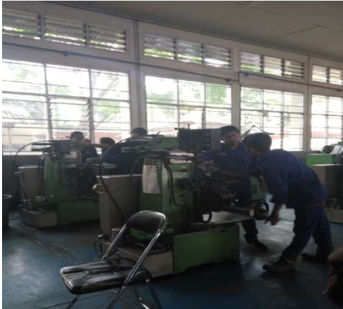
Gambar Facing besipejal (kotak)
