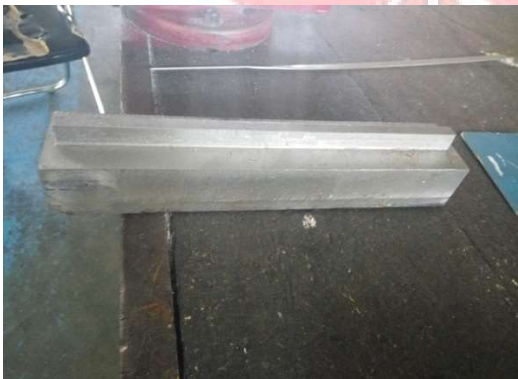
Gambar Pengeboran dan Pembuatan Alur
