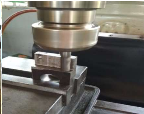
Gambar Pengeboran dan Pembuatan Alur
