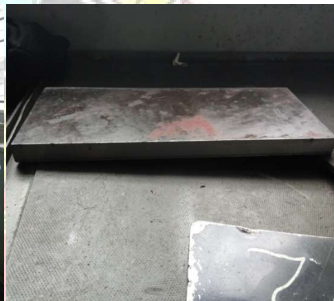
Gambar Facing besipejal (kotak)
