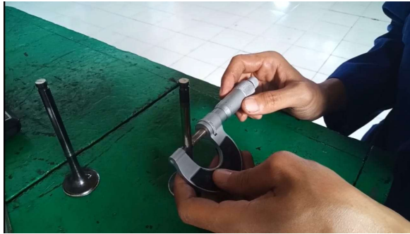
Gambar 3.47. Pengukuran Diameter Katup (Sumber : Arsip Pribadi)
