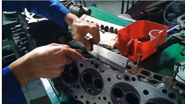
Gambar 3.45. Pengukuran Kerataan Manifold (Sumber : Arsip Pribadi)
