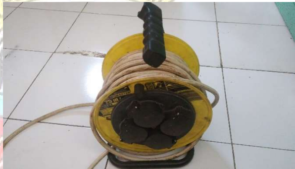
Gambar 3.7. Kabel Roll (Sumber : Arsip Pribadi)
