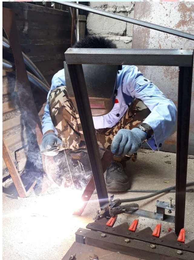
Pengelasan Stank Pengangkat Padi
