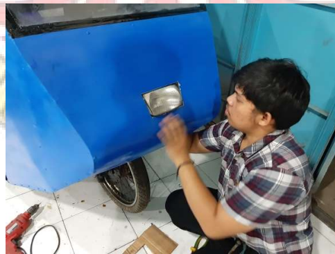
Gambar 4. 32 Pemasangan lampu utama pada bodi
