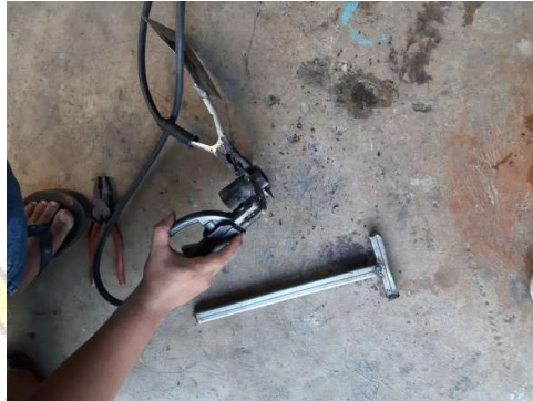
Gambar 4. 6 Pembuatan bracket piringan cakram
