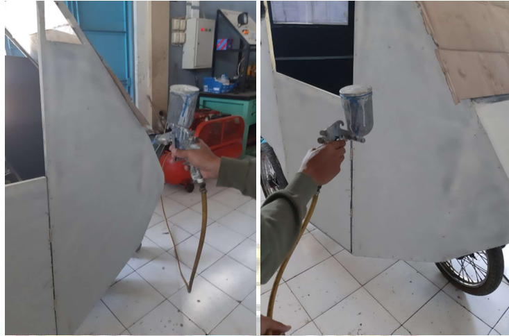
Gambar 4. 28 Proses pengecatan dasar bodi
