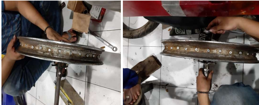
Gambar 4. 10 Pemasangan roda pada poros roda
