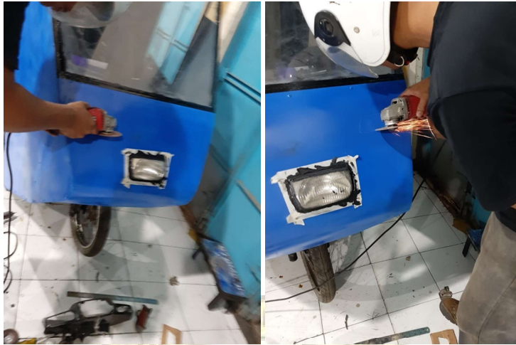
Gambar 4. 33 proses pembuatan lubang dudukan lampu sein dan lampu senja
