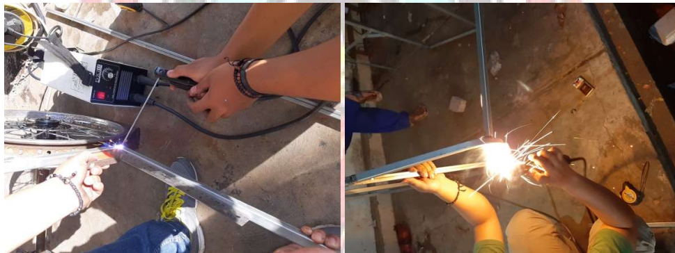
Gambar 4. 18 Pengelasan rangka bodi
