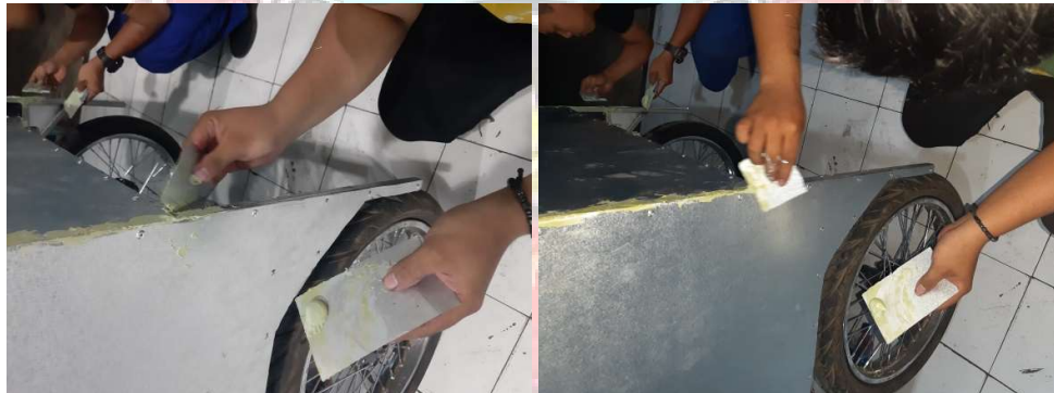
Gambar 4. 26 proses pendempulan bodi sepeda motor
