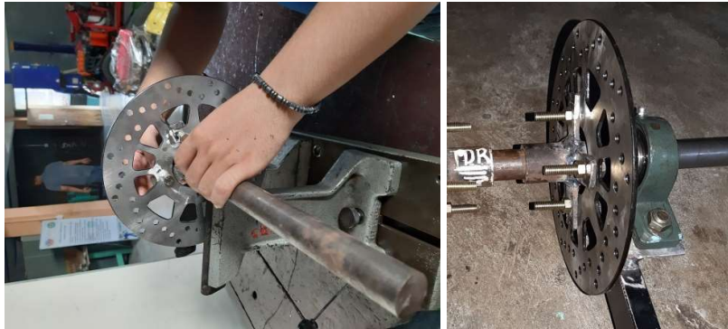
Gambar 4. 8 Pemasangan piringan cakram
