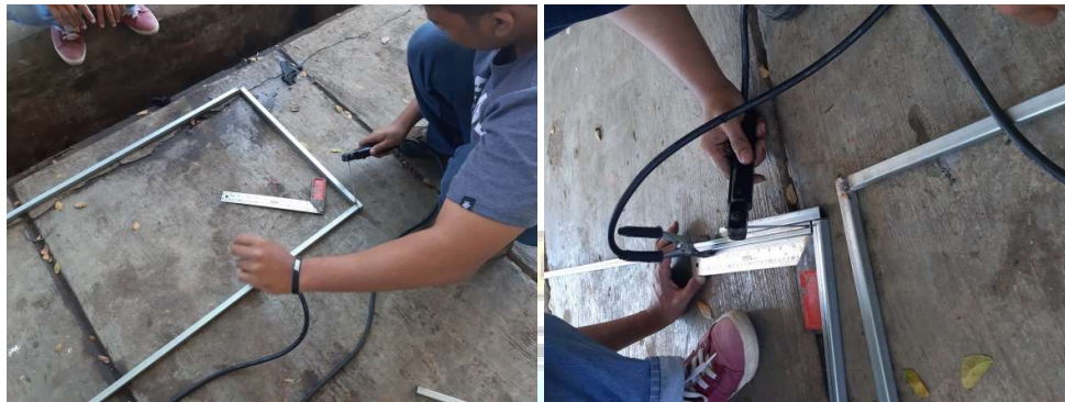
Gambar 4. 17 Penyambungan rangka bodi sepeda motor
