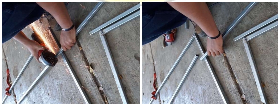
Gambar 4. 16 Pemotongan bahan rangka bodi
