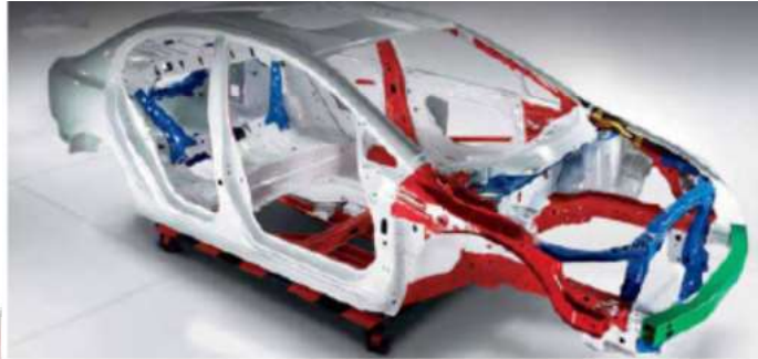
Gambar 2. 7 Konstruksi Menyatu (Monocoque Body) (Tim Fakultas Teknik Universitas Negeri Yogyakarta. 2004. Perkembangan Bodi Kendaraan)
