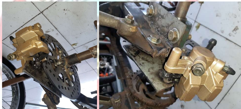
Gambar 4. 9 Pemasangan caliper rem cakram
