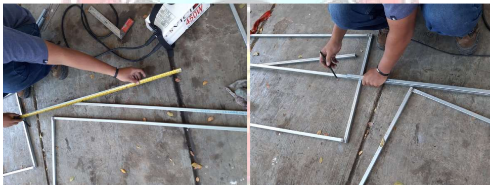
Gambar 4. 15 Mengukur bahan rangka bodi
