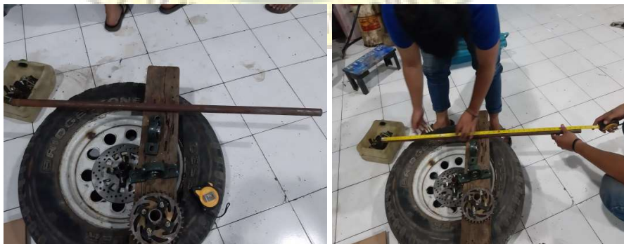
Gambar 4. 3 Pembuatan poros roda
