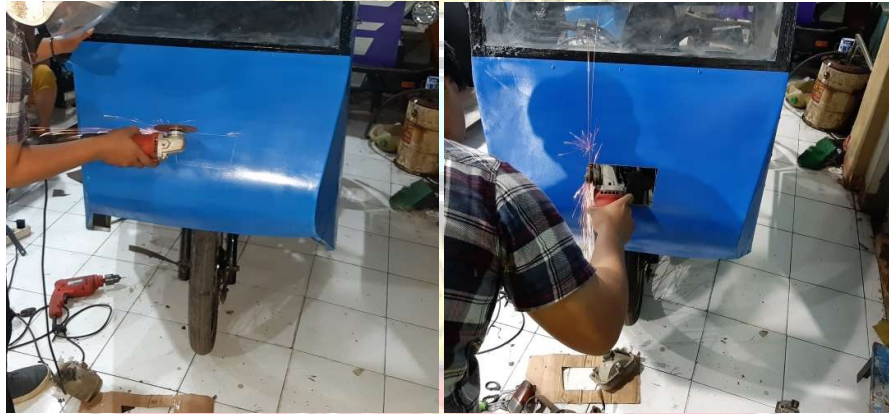
Gambar 4. 31 proses pelubangan tempat lampu utama
