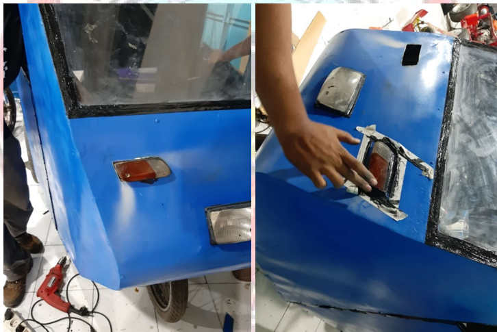
Gambar 4. 34 Proses pemasangan lampu sein kiri dan kanan
