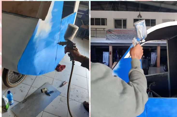
Gambar 4. 29 Pengecatan bodi sepeda motor
