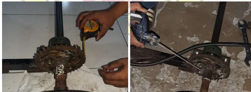
Gambar 4. 5 Pemasangan gear pada poros roda
