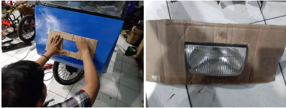
Gambar 4. 30 Pembuatan pola tempat dudukan lampu pada bodi
