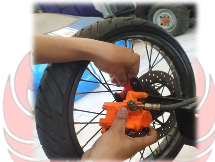
a. Memasang caliper rem
