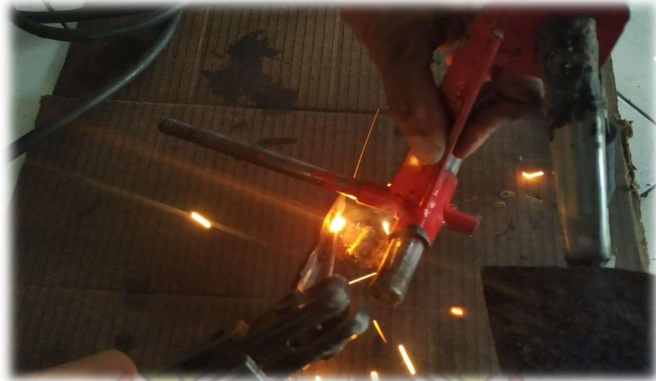
c. proses pengelasan pada dudukan caliper rem
