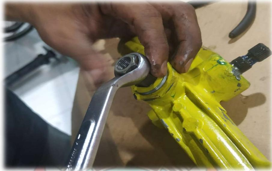
f. Memasang pengunci atau *locknut*
