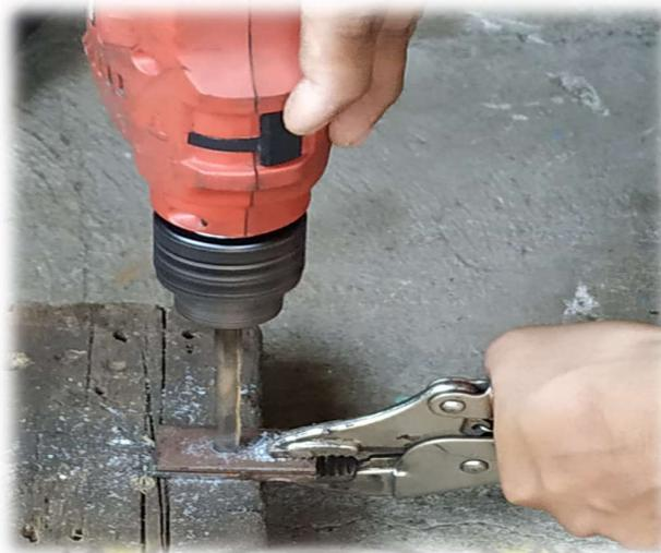
b. Membuat lubang untuk engsel batang pedal
