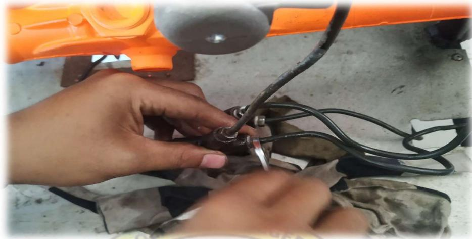
c. Pemasangan pipa minyak rem
