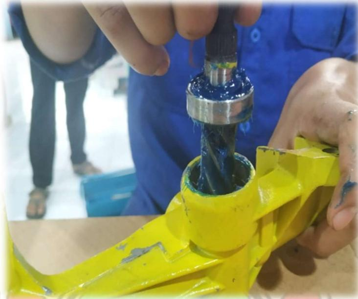
d. Pemasangan gear pinion
