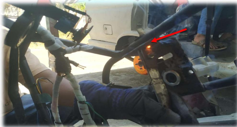
c. Pengelasan pada dudukan engsel pedal rem
