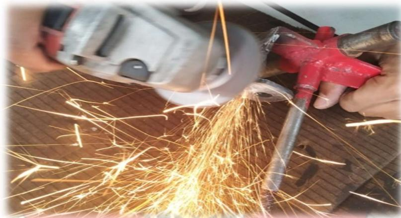
a. Memotong dudukan caliper rem
