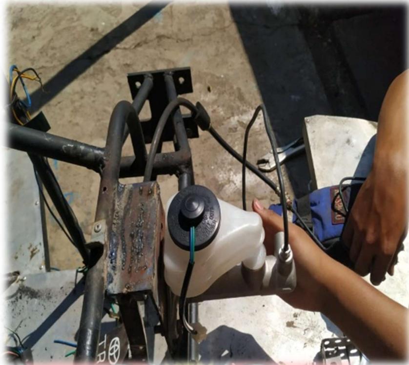
c. Memasang master rem ke dudukan master rem
