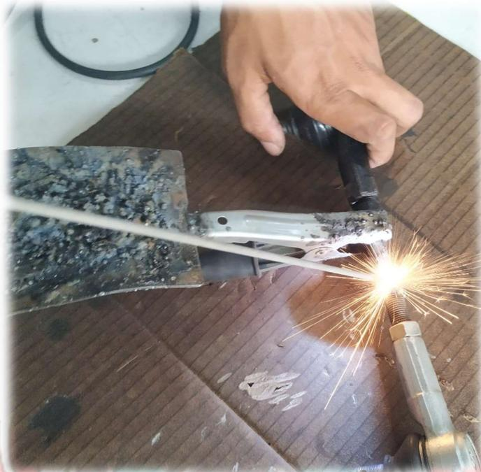
a. Proses pengelasan *tie rod* yang baru
