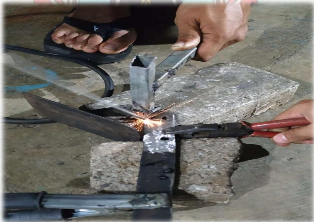
a. Pembuatan batang pedal rem
