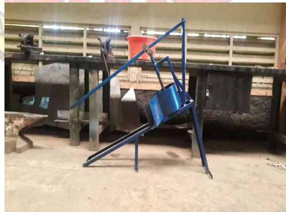
Gambar 2.6 Alat Pemipil dengan Penekan Manual
