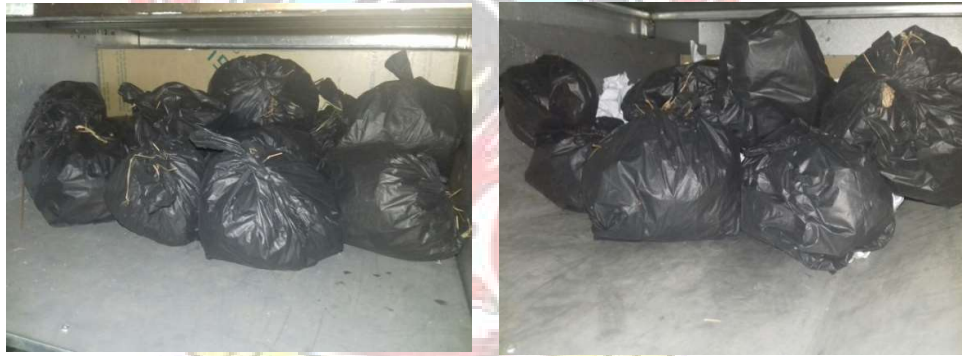
Gambar 4.9 Kondisi sampah dalam bak tanpa mekanisme pemadat
