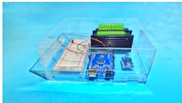
Gambar 4.6 Kotak Panel Kontrol
