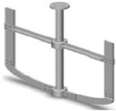
Gambar 2.5 Agitator dayung ( Paddle ) berdaun dua Sumber: Buku Petunjuk Satuan Operasi Politeknik Negeri Bandung, 2004
