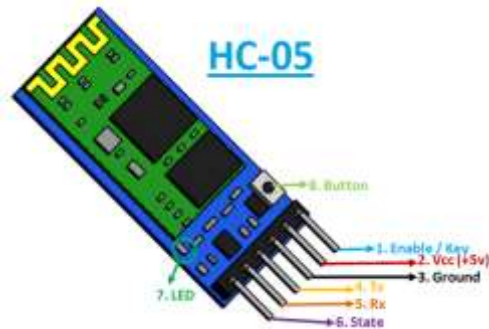
Gambar 2. 6 Konfigurasi Pin Modul Bluetooth Hc-05
