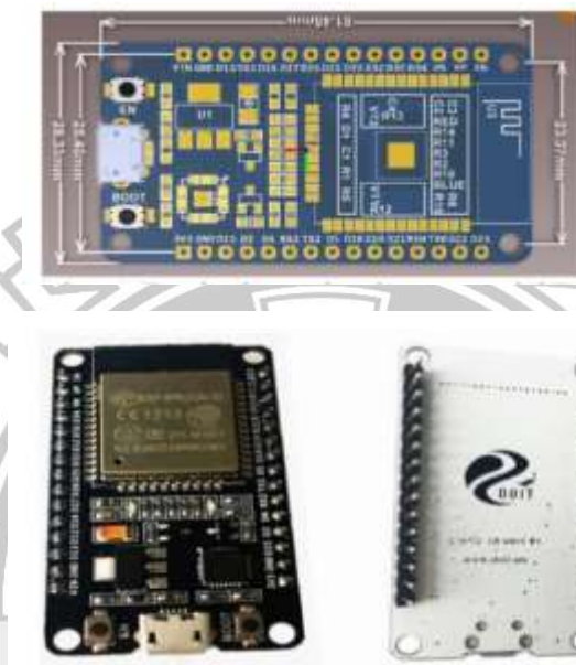
Gambar 2.3 Tata Letak Pin dan Dimensi Modul DOIT ESP32
