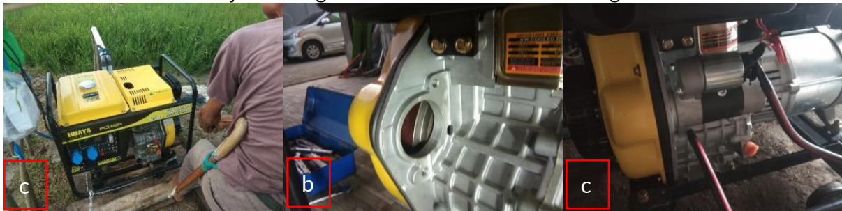
Gambar 8. Modifikasi starter manual genset diesel ke starting elektrik
