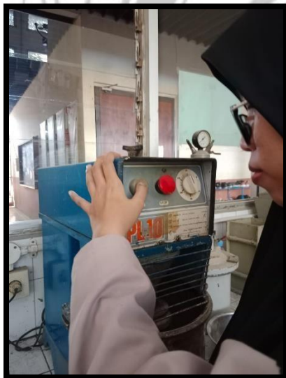
Menekan tombol start pada mixer, dan dinyalakan hingga \pm 15 menit
