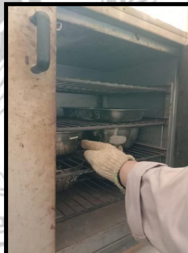
Mengeluarkan Sampel Agregat dari Pinkometer, lalu di Oven.
