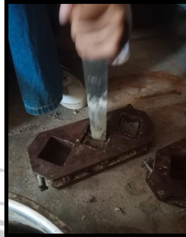
Memasukkan campuran kedalam cetakan yang telah diberi vaselin. Lalu didiamkan selama \pm 24 jam
