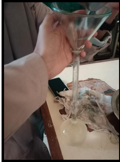
Mengisi Botol Le Chatelier dengan minyak tanah.
