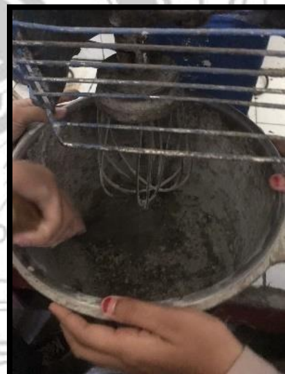
Membersihkan pasta pada dinding mangkuk menggunakan spatula.
