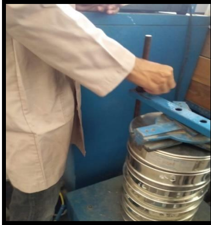
Mengencangkan baut pencunci alat penggetar lalu dinyalakan selama \pm 15 menit.
