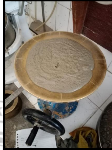
Mengukur diameter pasta sebanyak 4 kali ( d_1, d_2, d_3 dan d_4 ) lalu menghitung rata-ratanya.
