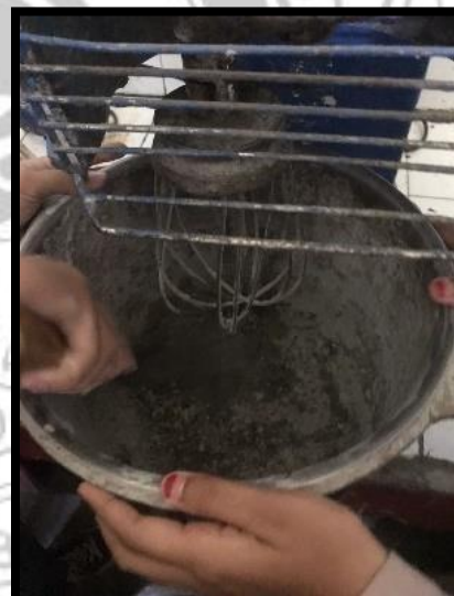
Membersihkan pasta pada dinding mangkuk menggunakan spatula.
