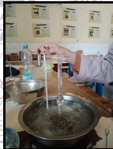
Memasukkan botol Le Chatelier yang berisi minyak tanah dan semen kedalam cawan berisi es batu. Lalu mengamati termometer. Bila suhu telah mencapai maka membaca skala dan mencatat V_2 .
