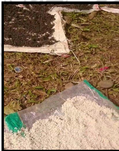
Mengangin-anginkan Sampel Agregat Hingga Kondisi SSD.
