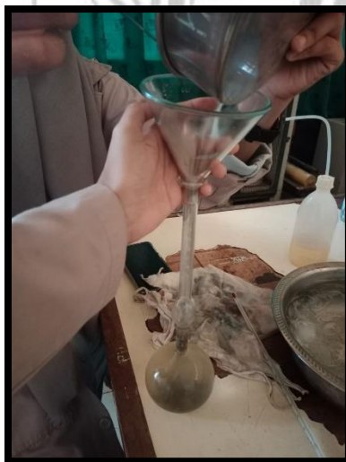
Setelah pembacaan V_1 , mengeluarkan botol Le Chatelier dan dikeringkan, lalu menambahkan semen kedalam botol Le Chatelier yang berisi minyak tanah.
