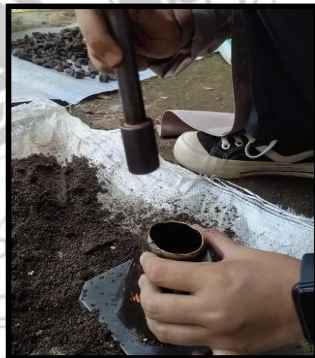
Menguji Kondisi SSD Sampel Agregat Dengan Kerucut.
