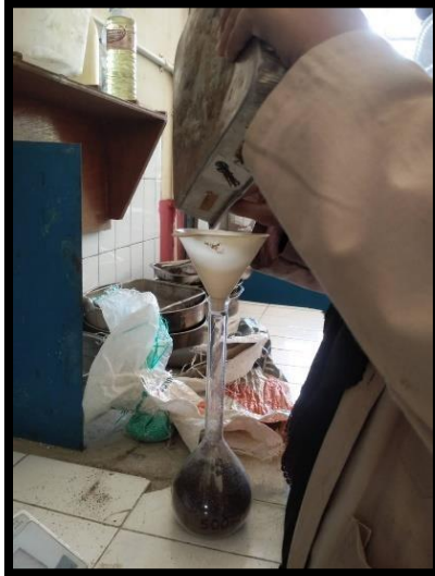
Memasukkan Sampel agregat yang SSD kedalam piknometer sebanyak 500gr.
