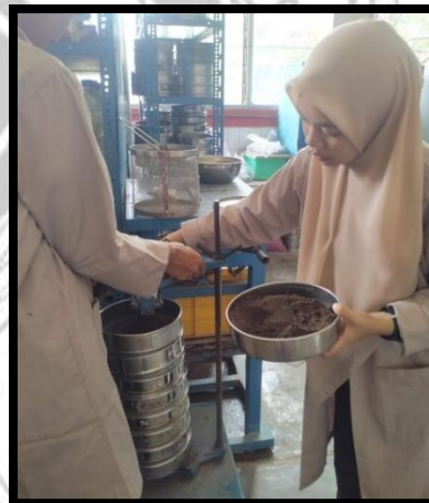
Memasukkan agregat kedalam saringan.
