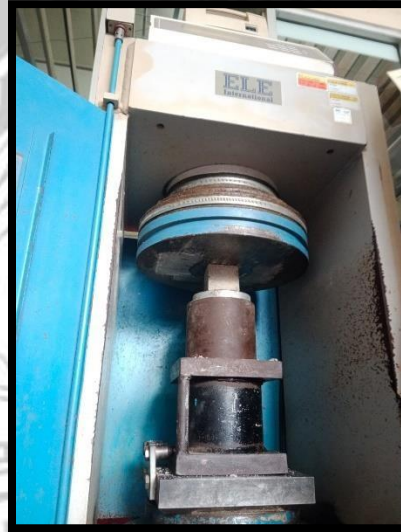
Melakukan pengujian kuat tekan dengan mesin uji kuat tekan.
