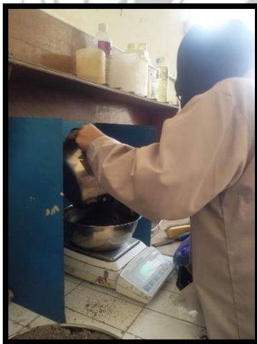
Menimbang sampel sebelum dioven dan mencatat hasilnya ( W_1 )
