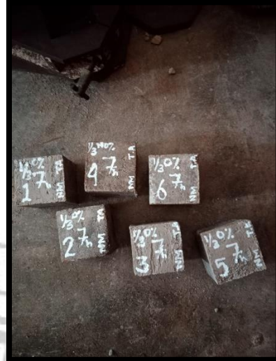
Mengangkat Sampel yang telah memenuhi umur perencanaan dan didiamkan selama \pm 24 jam.
