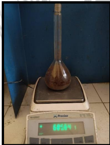
Menimbang berat Piknometer + Sampel Agregat + Air
