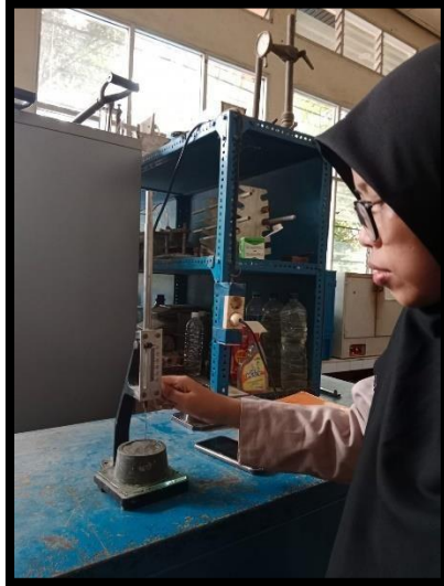
Memasukkan cincin konik dan plat kaca yang berisi pasta kedalam alat vicat.
