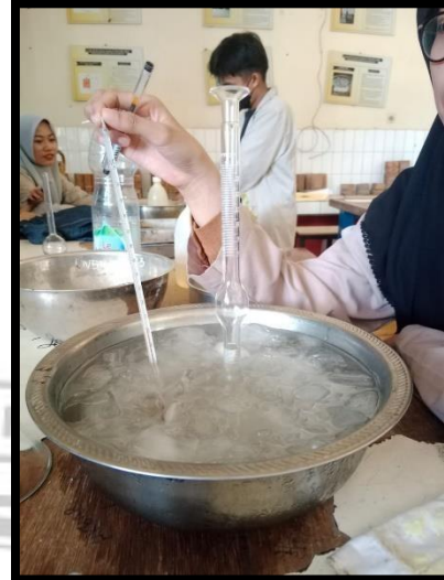
Memasukkan Botol Le Chatelier yang berisi minyak tanah kedalam cawan yang berisi es batu lalu mengamati termometer dan mencatat ( V_1 )
