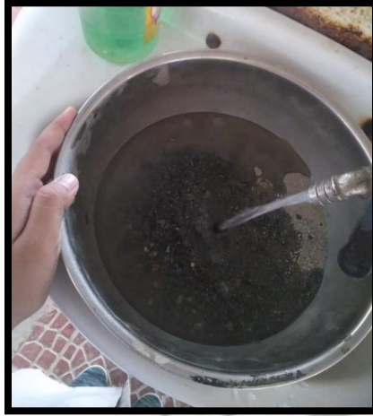
Mencuci Sampel agregat
