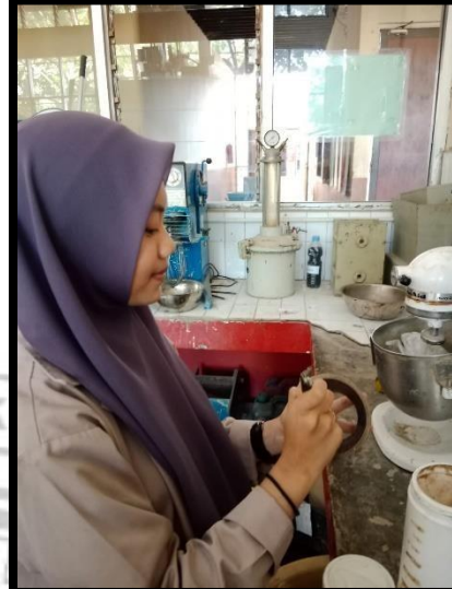
Mengoleskan Vaseline pada cincin konik.
