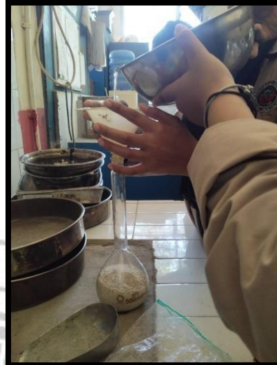
Mengisi piknometer dengan air.
