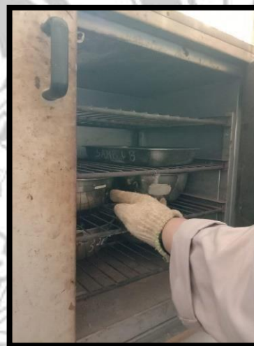
Memasukkan sampel kedalam oven dengan suhu 110^{\circ}\text{C} selama \pm 24 jam
