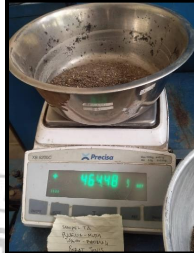
Menimbang sampel agregat yang telah dioven.
