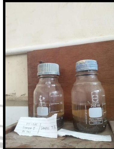
Mendiamkan botol yang berisi sampel selama \pm 24 jam.
