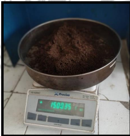
Menimbang agregat yang akan disaring sebanyak 2500gr masing-masing agregat.
