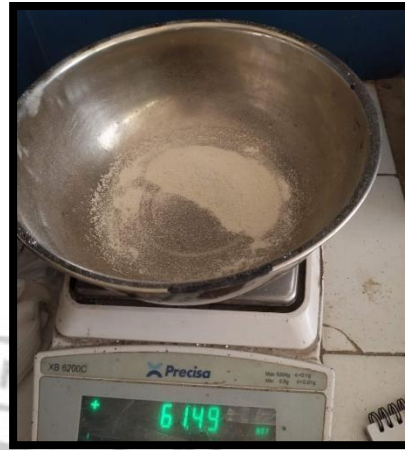
Menimbang berat agregat yang tertahan dimasing-masing saringan Lalu mencatat hasilnya.
