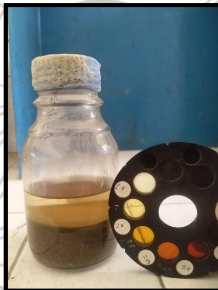
Mengamati warna dengan tabel warna/abrams.
