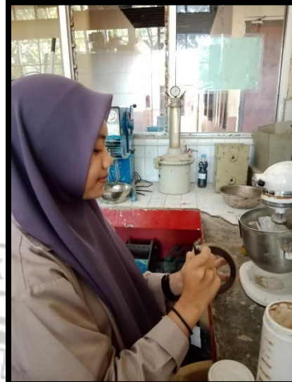
Mengoleskan Vaseline pada cincin konik.
