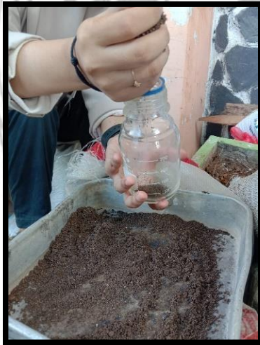
Mengisi botol 1/3 bagian dengan sampel agregat.
