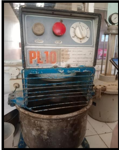
Mencampur agregat hingga homogen.
