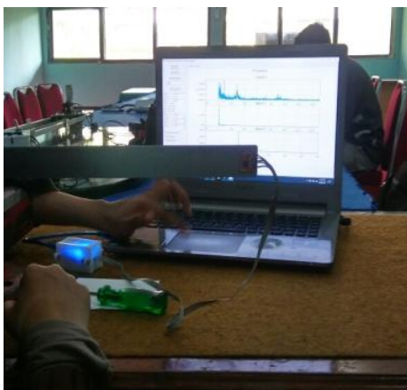
Gambar 9a. Eksperimen getaran bebas
