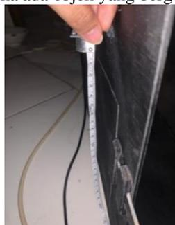
Gambar 14. Pengujian Sensor Ultrasonik
