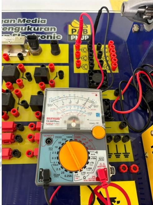
Gambar 4. 14 Pengujian Transistor Secara Actual
