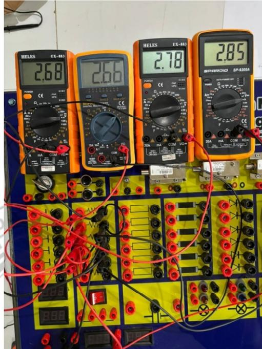
Gambar 4. 9 Pengujian Rangkaian Pararel Secara Actual
