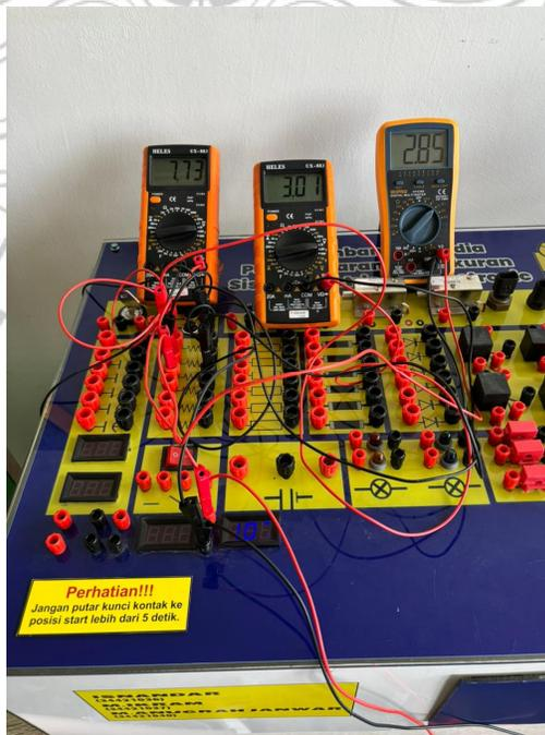
Gambar 4. 7 Pengujian Rangkaian Seri Secara Actual
