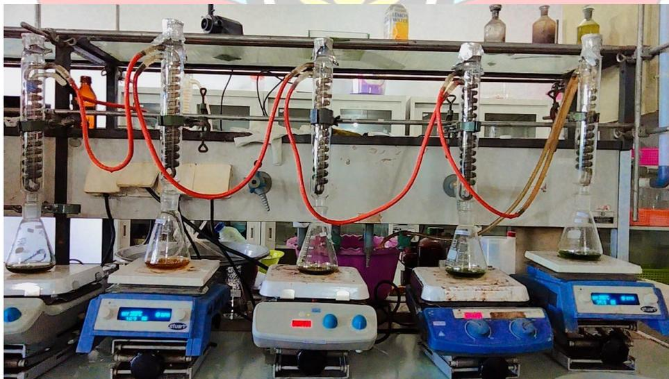
Foto Proses Refluks pada Pengujian COD
