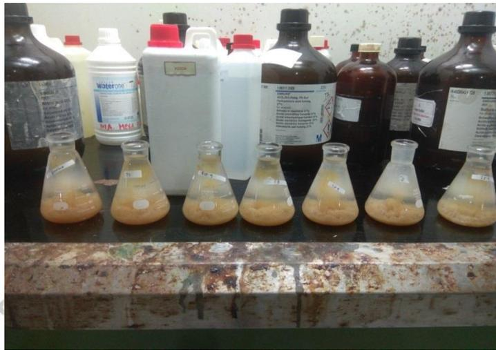
Foto Proses Penambahan  $MnSO_4$  dan Alkali Iodida Azida pada Pengujian BOD
