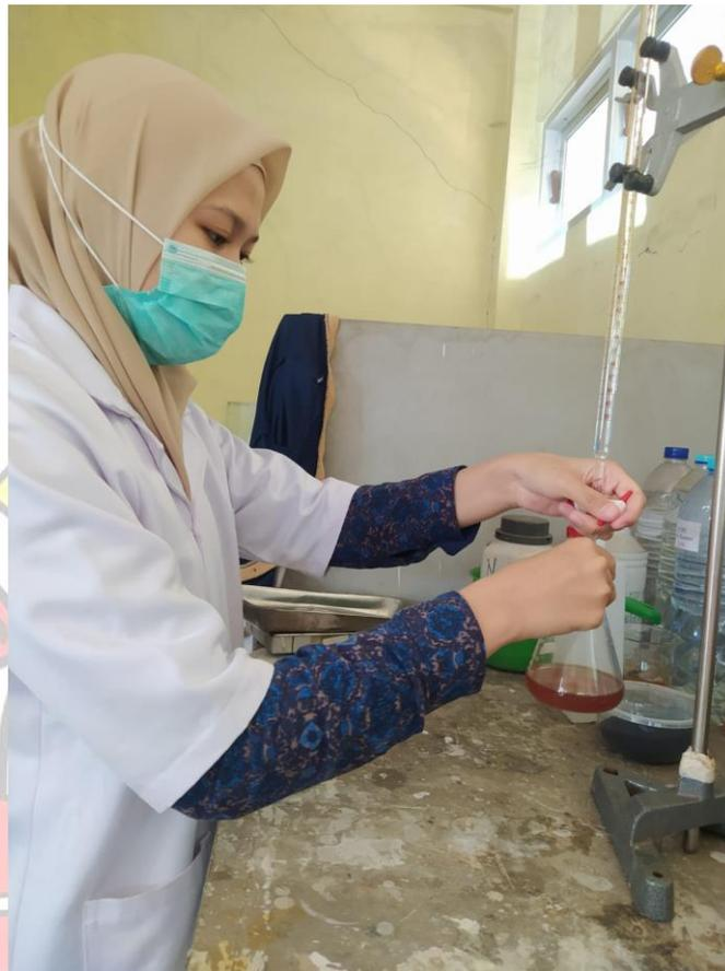
Foto Proses Titrasi pada Pengujian COD
