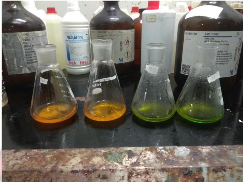
Foto Proses Penambahan Larutan Pereaksi  $H_2SO_4$  pada Pengujian COD
