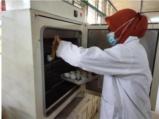
Foto Karakterisasi Pengujian Kadar Air
