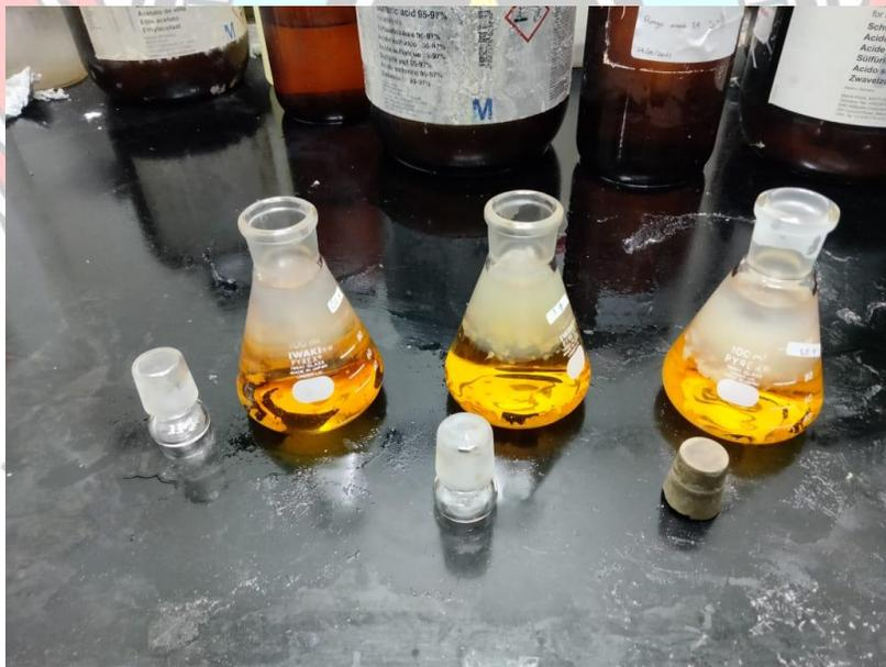
Foto Proses penambahan  $H_2SO_4$  pada Pengujian BOD
