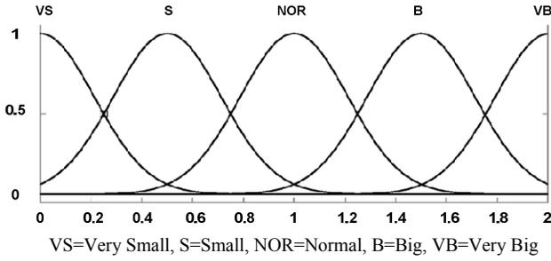
Fig. 9. Input variable MF –  $P_g$  (pu)
